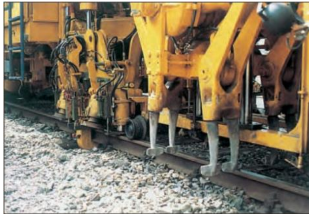
Figura 2.31. Máquina de bateo. [1]
