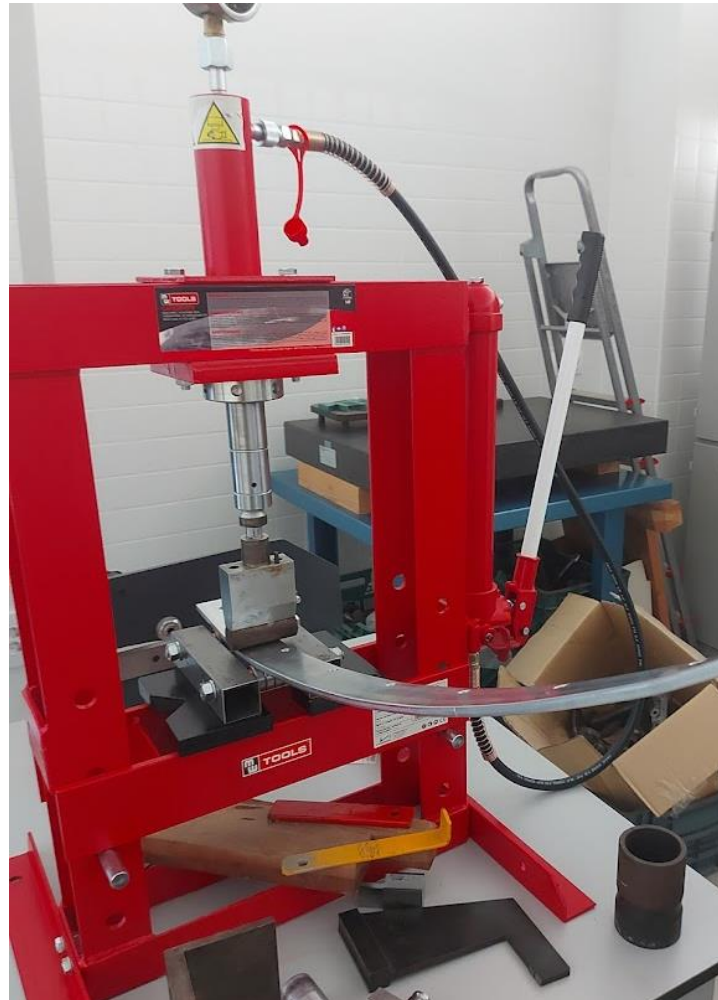
Figura 4.63. Proceso de plegado con prensa hidráulica
