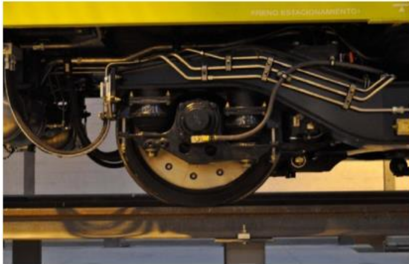
Figura 2.42. Suspensión primaria de un bogie. Fuente: Internet
