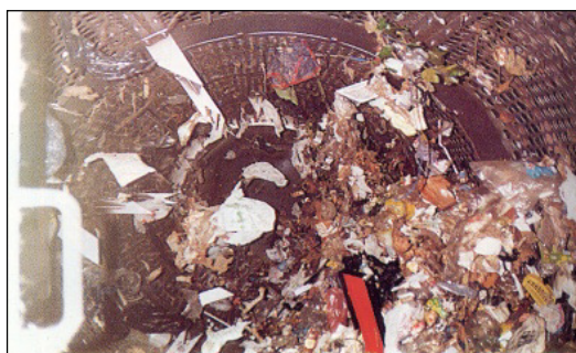
Figura 2.10: Clasificación de materiales en un trommel
