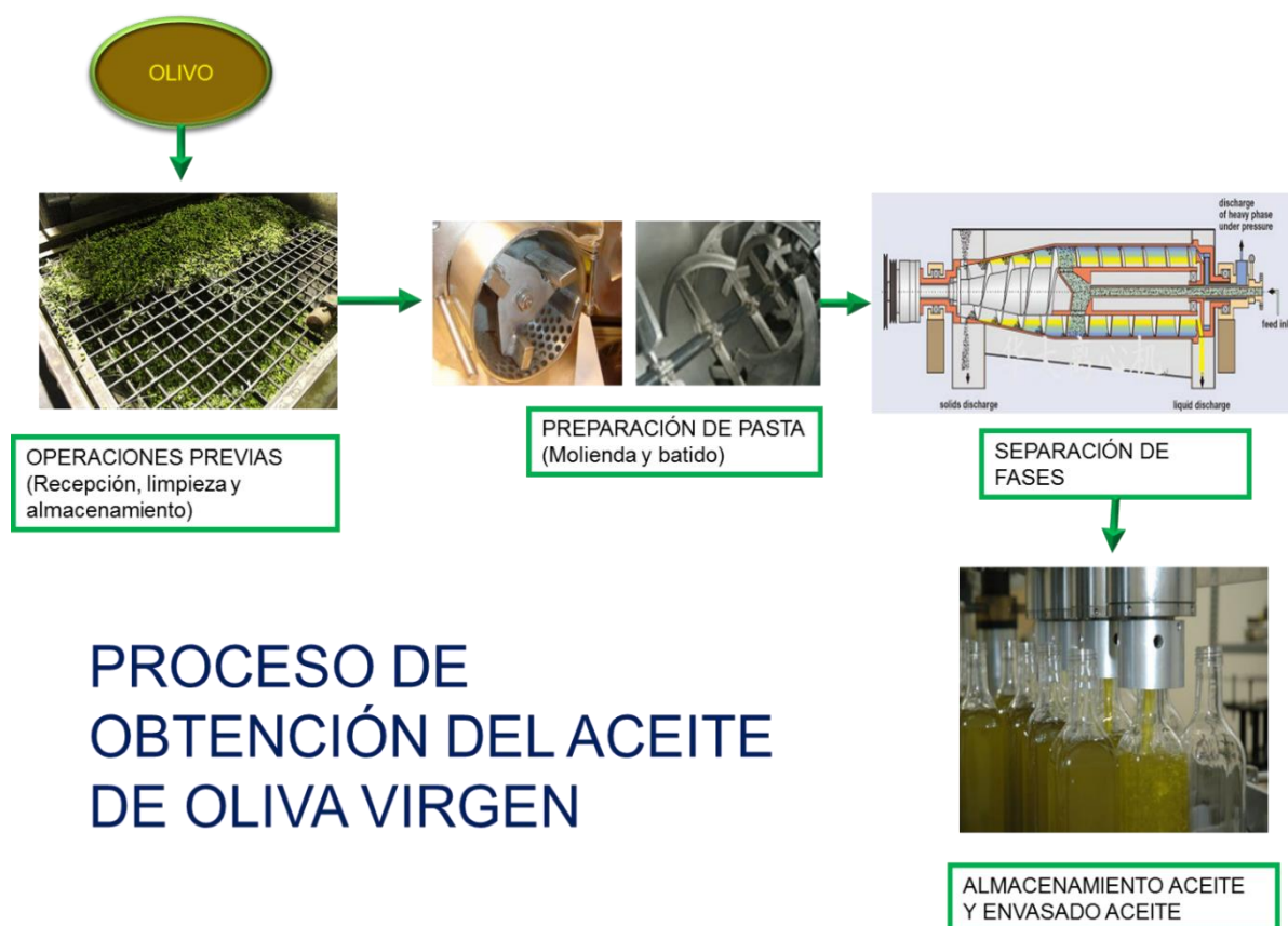
Figura 2.9. Proceso de obtención de Aceite de Oliva virgen. Fuente: elaboración propia.
