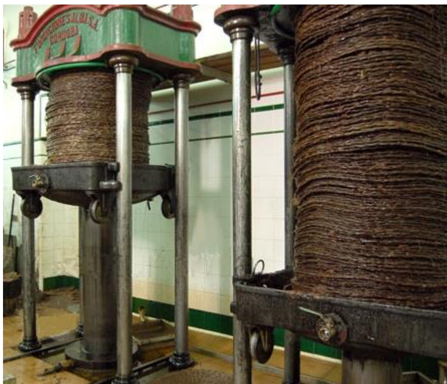
Figura 2.11. Sistema de prensas para la extracción de aceite de oliva.
