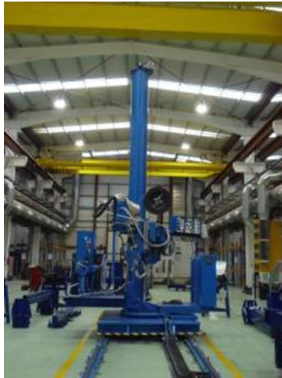
Ilustración 28. Columna soldadura por arco sumergido.
