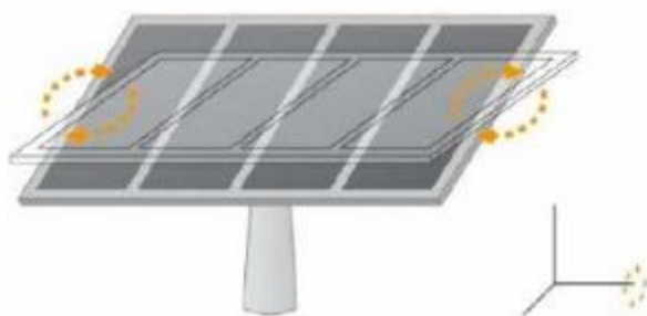
Figura 3. Seguidor Solar de un eje
