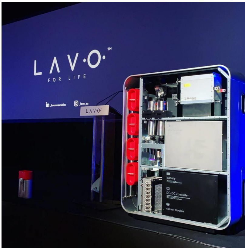
Ilustración 12. Diseño de la batería de hidrógeno doméstica Lavo.
