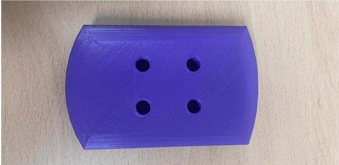
Ilustración 22. Matriz impresa cara superior; FUENTE: [Propia]
