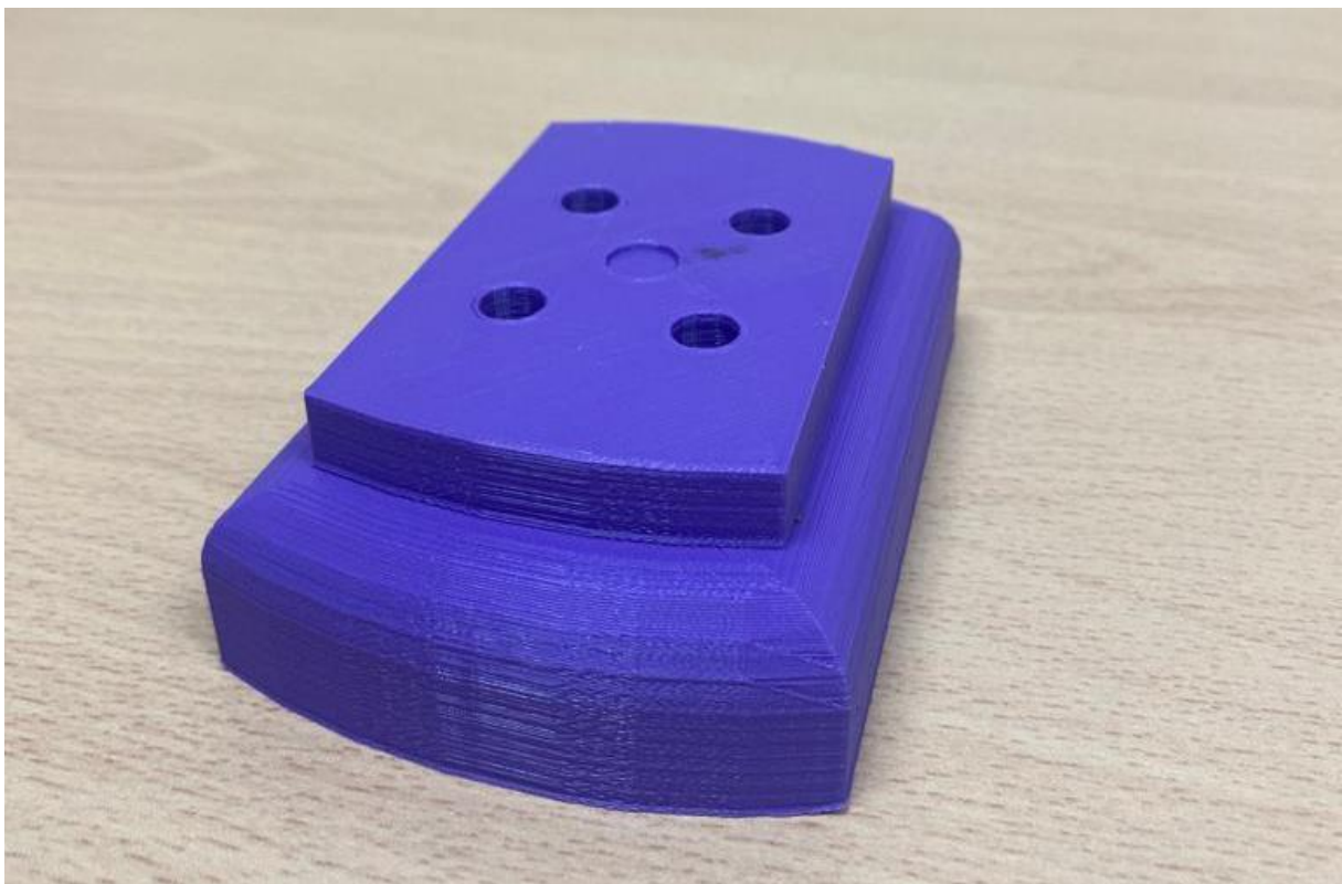
Ilustración 27. Conjunto matriz y pisador impresos lateral; FUENTE: [Propia]
