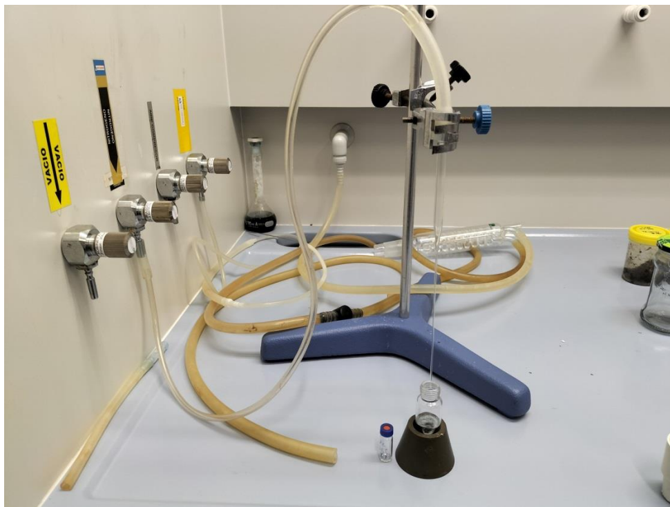
Imagen 14. Separación del n-hexano de la muestra mediante corriente de Nitrógeno gas.
