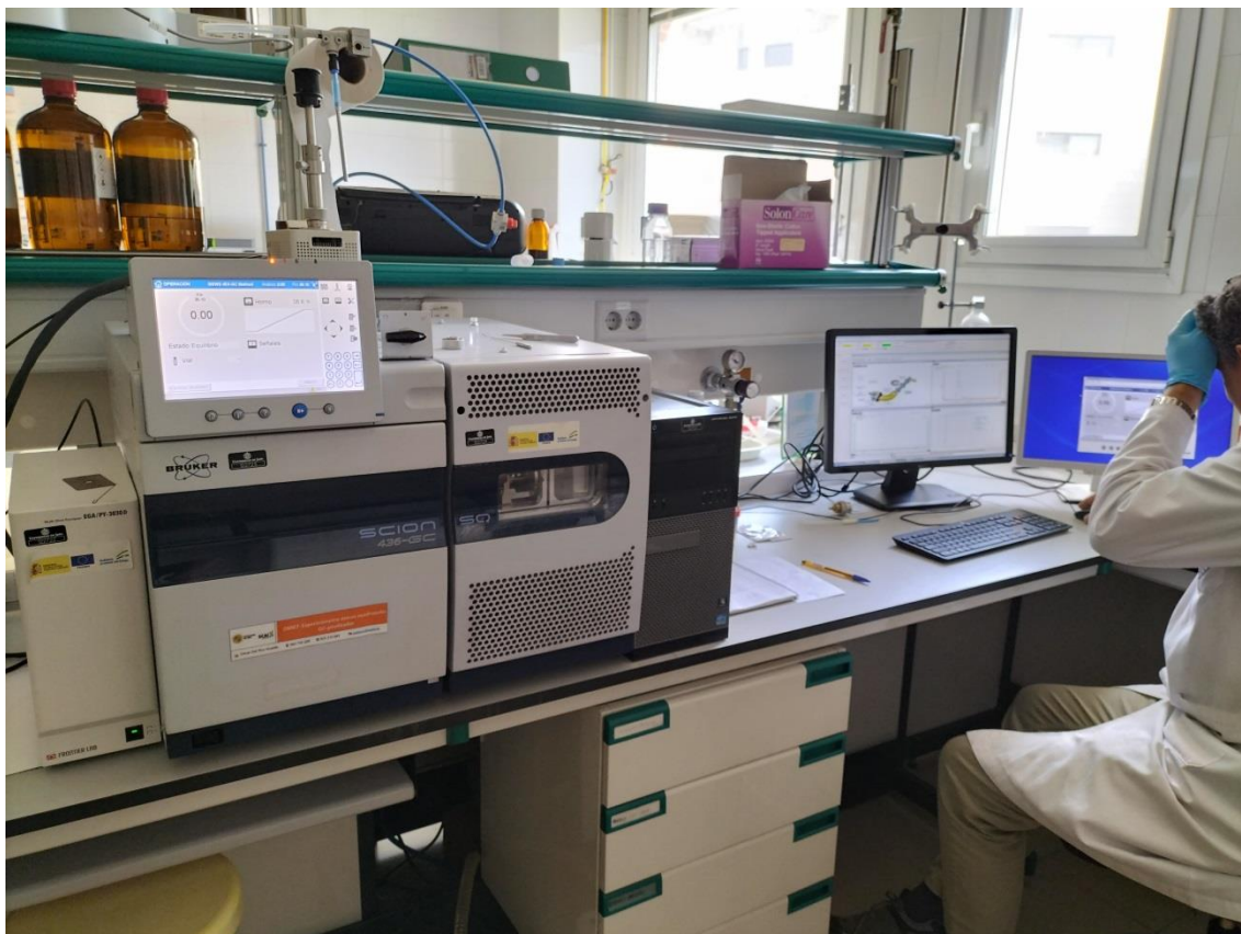
Imagen 2. Distintas imágenes del equipo pirolizador + espectrómetro de masas.
