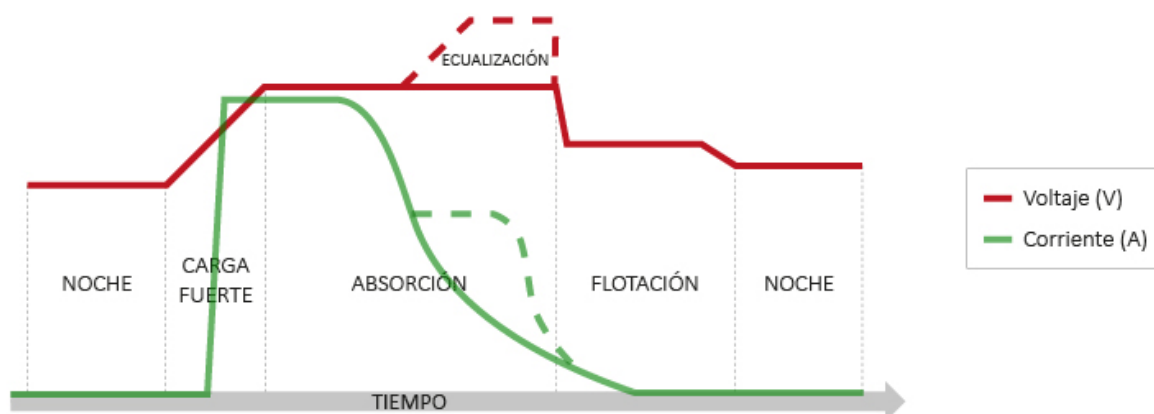
Figura 33. Diagrama etapas de carga de baterías
