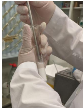
Figura 7. Homogenización de tejido utilizando un homogenizador Potter-Elvehjem.
