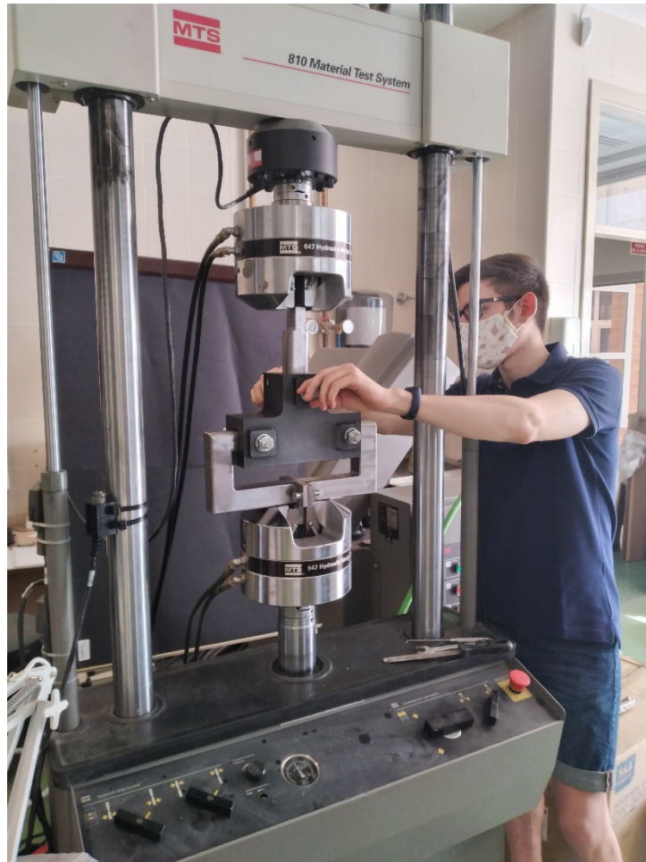
Ilustración 8.16: Ajuste de los tornillos de la pieza a los útiles.
