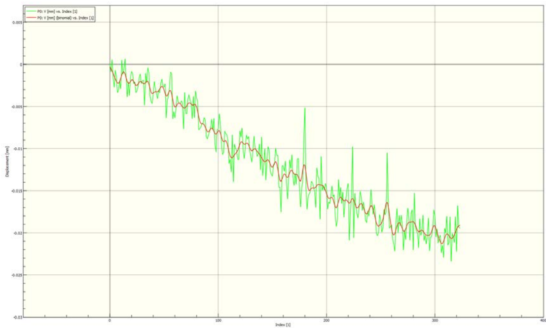
Ilustración 8.27: Gráfica de desplazamiento vertical frente a imágenes en Prototipo 2: Ensayo elástico a tracción. En verde los datos sin refinar. En rojo los datos tras el postprocesado.
