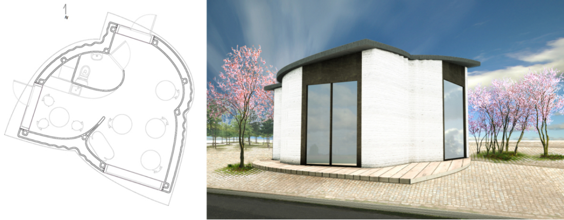
Ilustración 2.9: Planta y render de “The BOD”, la primera construcción impresa en 3D en Europa [12].
