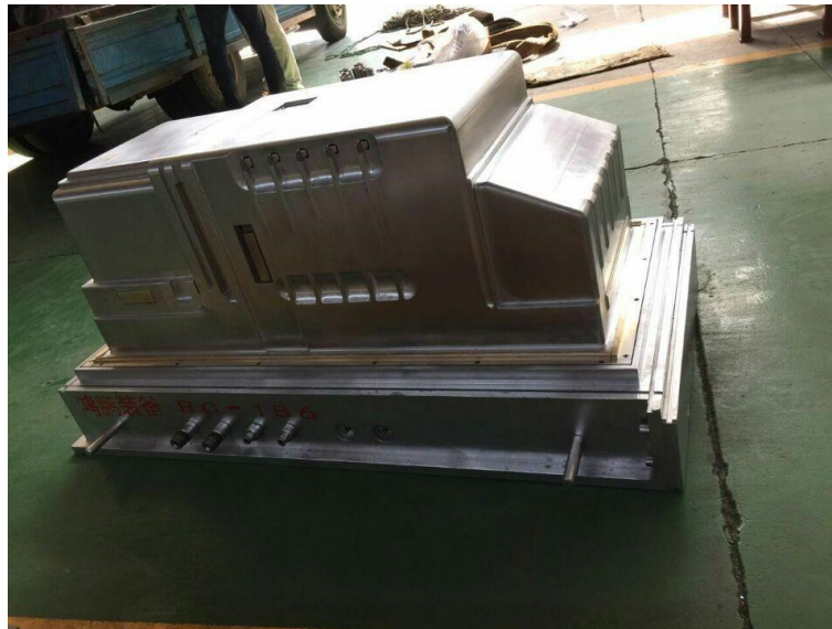
Ilustración 1 Ejemplo de Molde para el termoformado de la cuba. Fuente: https://hpzbmj.en.alibaba.com/es_ES/?spm=a2700.details.cordpanyb.2.72f879eau3uN3p
