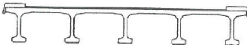
Figura 3: Sección transversal de vigas prefabricadas.[1]
