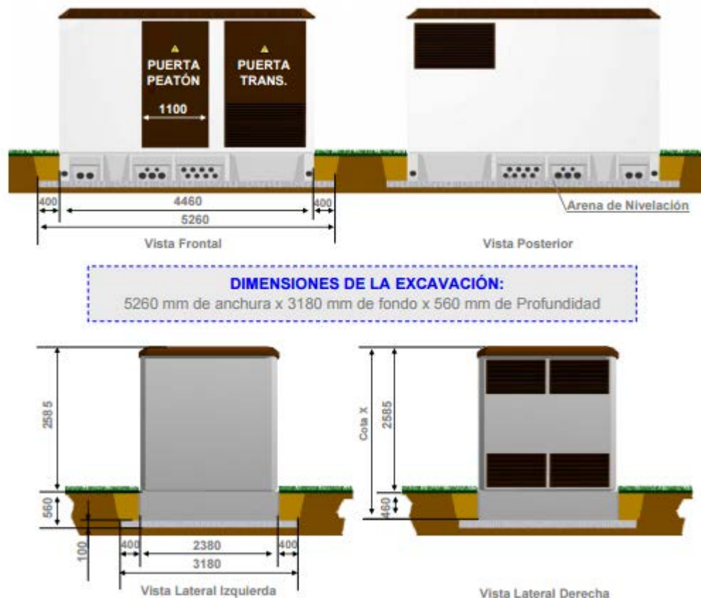
Figura 8.4 Dimensiones del receptáculo
