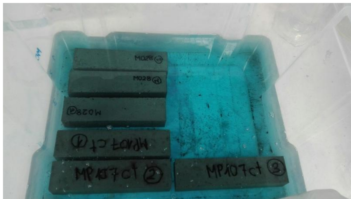
Figura 3.8. Probetas sumergidas en acetona
