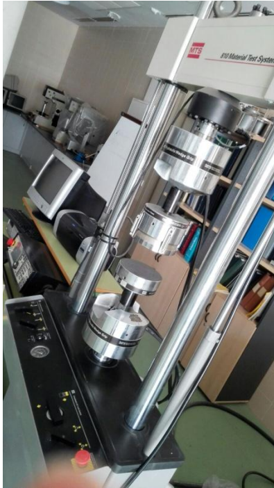
Figura 3.15. Máquina de resistencia a la compresión del laboratorio y utensilio empleado
