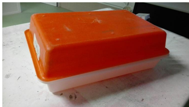
Figura 3.13. Bandeja cubierta para evitar evaporación
