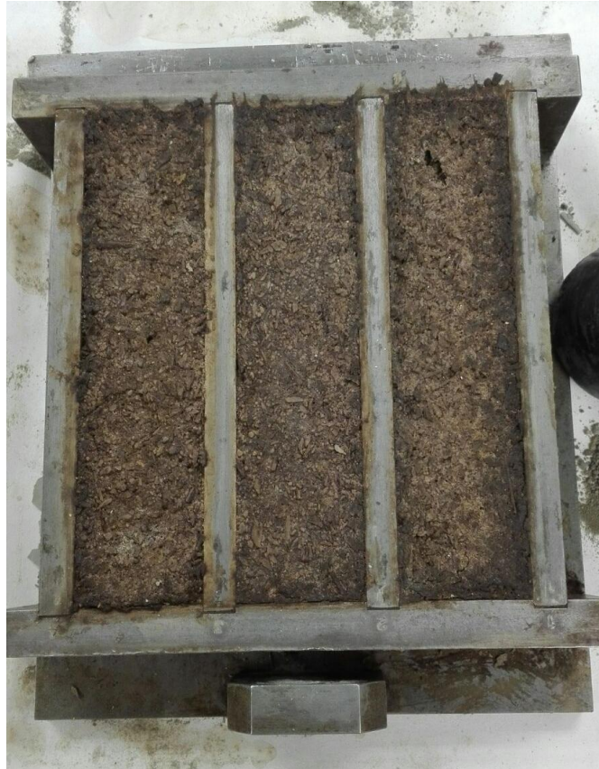
Figura 3.7. Moldes con morteros en proceso de fraguado
