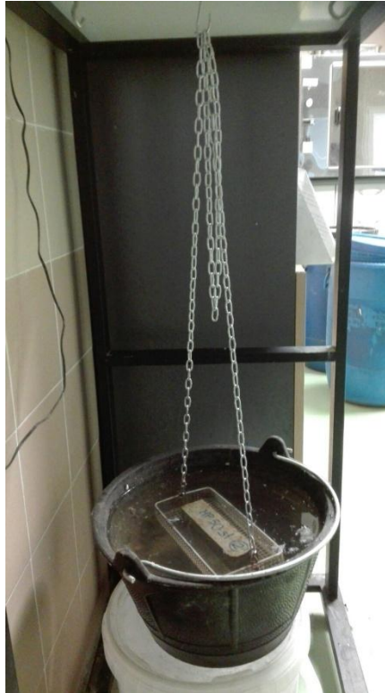
Figura 3.11. Probeta en balanza hidrostática
