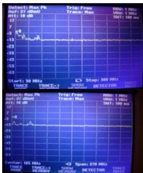
Figura 141. Comparación de los espectros de ruido con y sin ferrita
