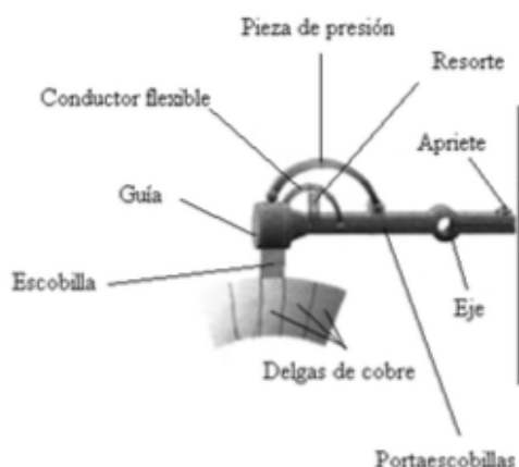
Figura 53. Esquema de un colector de delgas de un motor de CC
