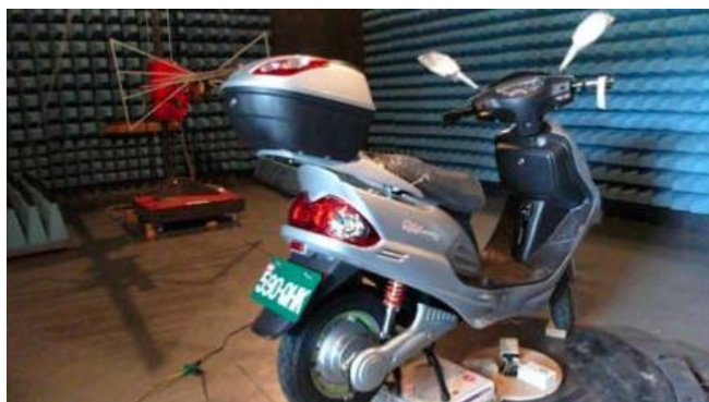
Figura 135. Motocicleta en evaluación de interferencia del campo lejano
