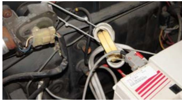
Figura 139. Utilización de la ferrita para reducir el ruido
