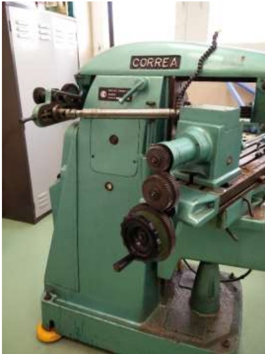
Imagen 53 Sin protección en el lateral de la máquina
