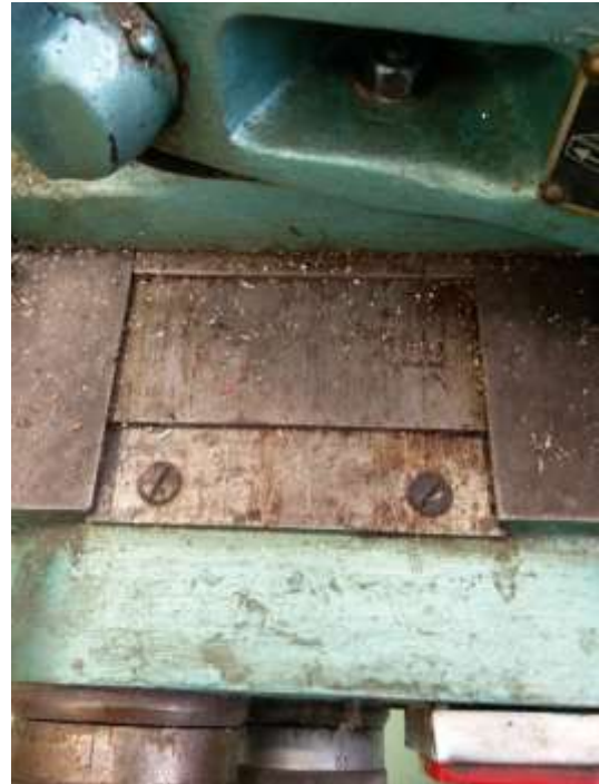
Imagen 54 Riesgo de atrapamiento por el movimiento de las guías
