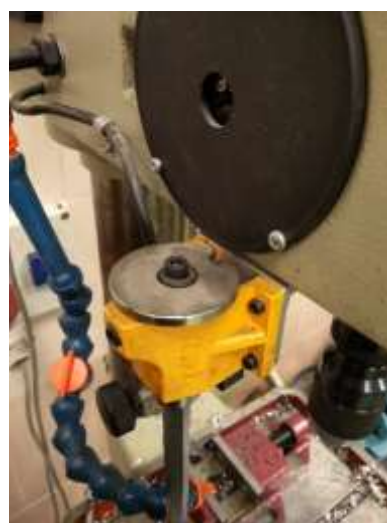
Imagen 21 Enclavamiento del resguardo móvil
