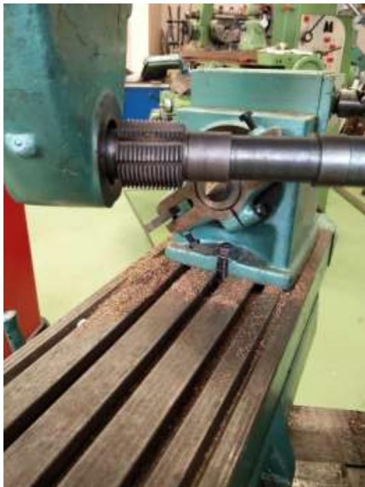
Imagen 55 Sin resguardo móvil antiproyecciones
