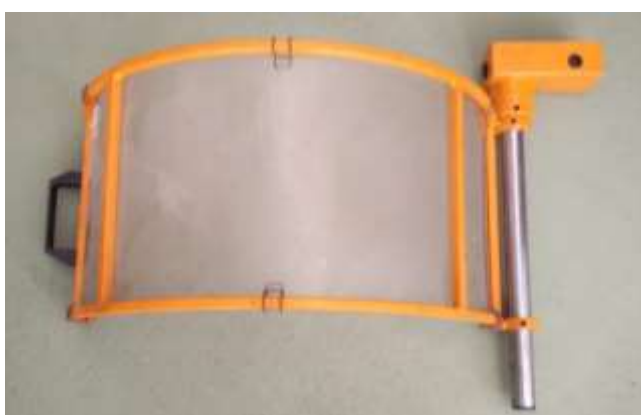
Imagen 17 Resguardo móvil quitado de la máquina
