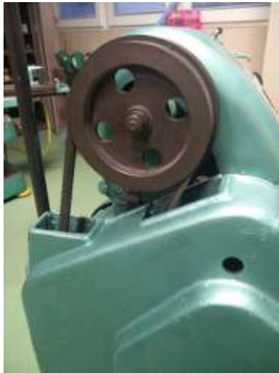
Imagen 40 Sistema de transmisión por poleas
