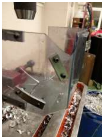
Imagen 23 Rotura del resguardo móvil
