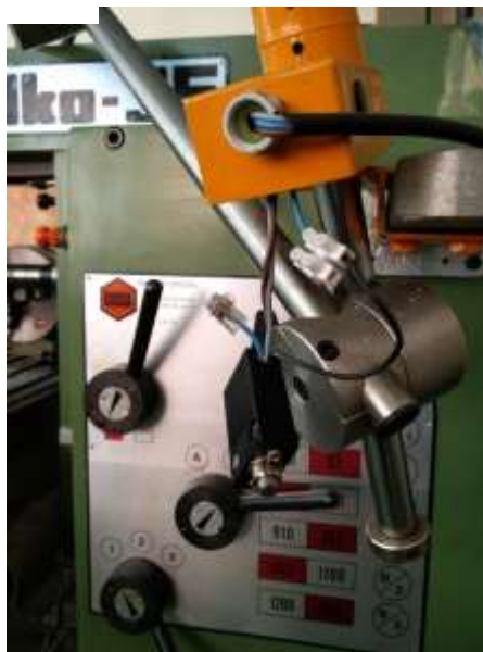
Imagen 16 Empalme en el enclavamiento
