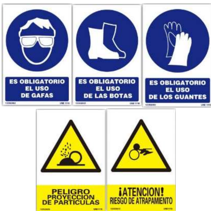
Imagen 18 Solución correspondiente a la señalización visual de los riesgos de la máquina
