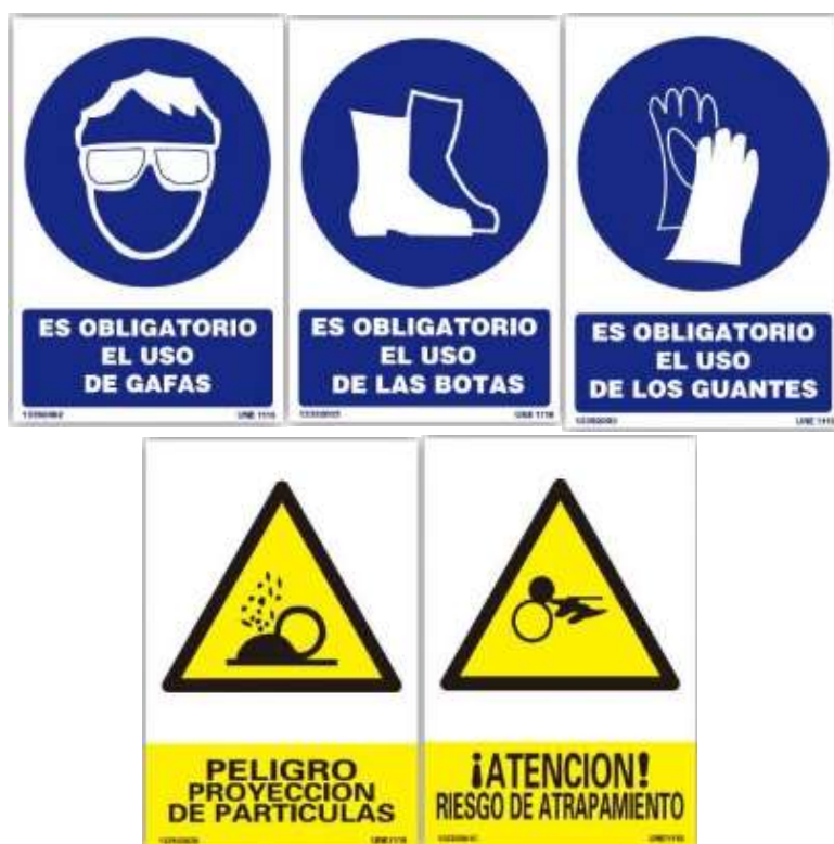
Imagen 49 Solución correspondiente a la señalización visual de los riesgos de la máquina
