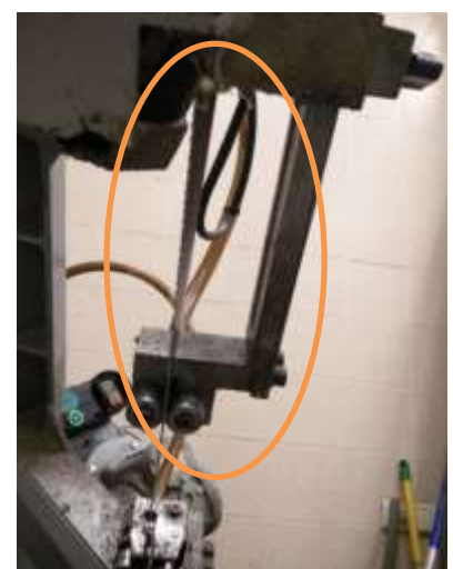
Imagen 33 Hoja de la sierra, modificación para su protección
