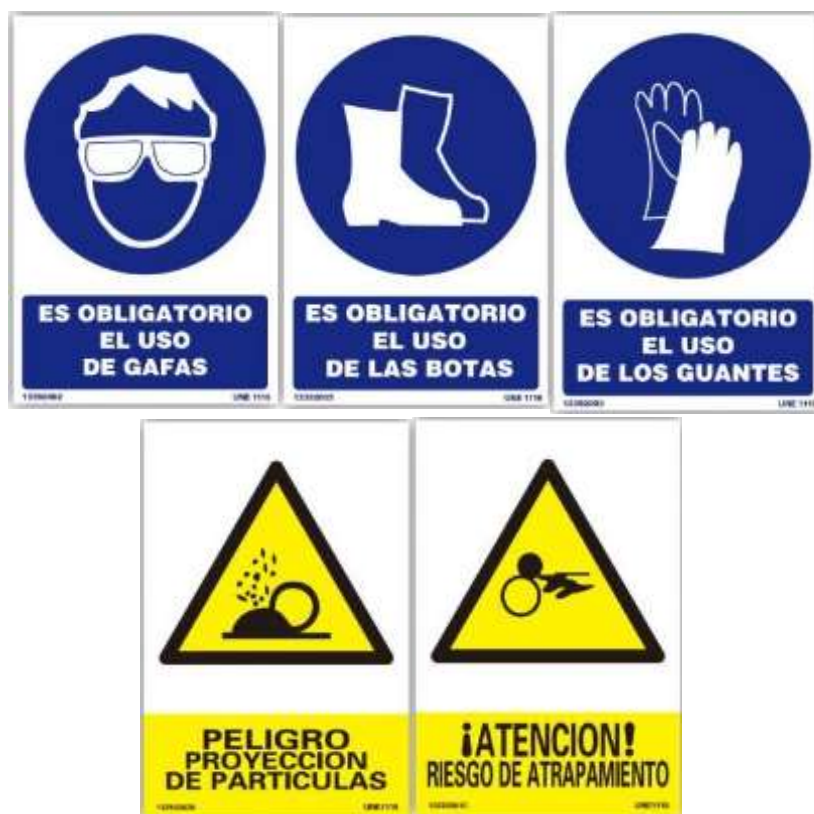
Imagen 36 Solución correspondiente a la señalización visual de los riesgos de la máquina
