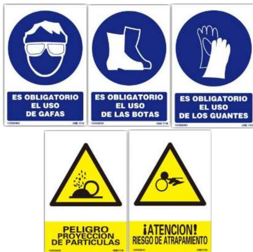
Imagen 8 Solución correspondiente a la señalización visual de los riesgos de la máquina
