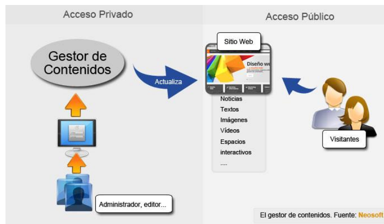
Ilustración 2.10 Ejemplo 2 – funcionamiento CMS
