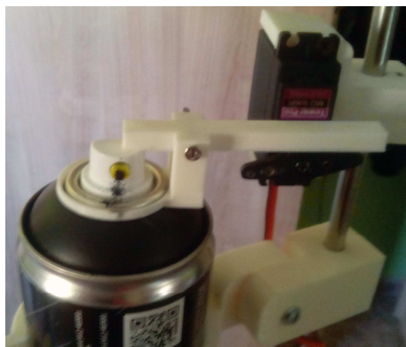
Ilustración 3.5.4 Sistema de palanca servomotor – bote de spray
