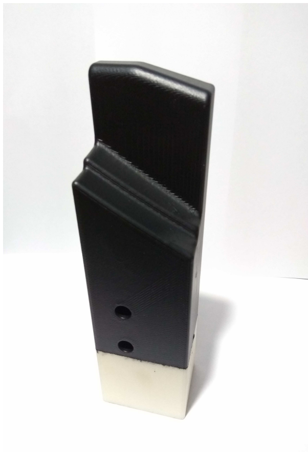
Ilustración 6.3 Pieza de FDM tras acabado superficial
