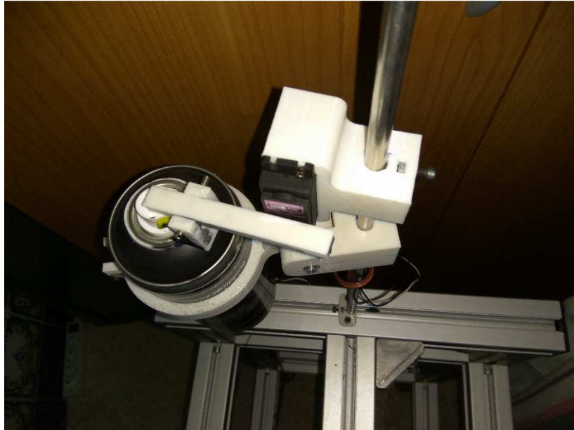
Ilustración 4.4.2 Posición final sistema de pintado
