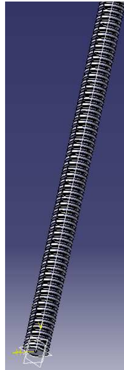
Ilustración 3.1.6.d Husillo de 8 mm de diámetro y paso 2 mm
