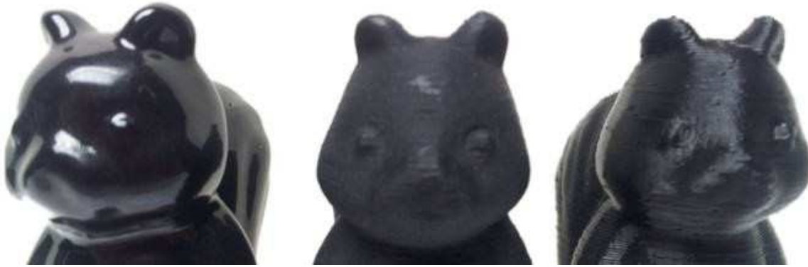
Ilustración 2.1 Distintos tratamientos superficiales en una pieza fabricada mediante FDM (Impresoras3d, 2016)
