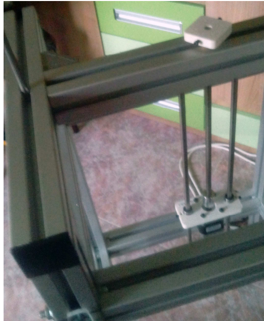
Ilustración 3.5.3 Montaje de la parte móvil del ensamblaje
