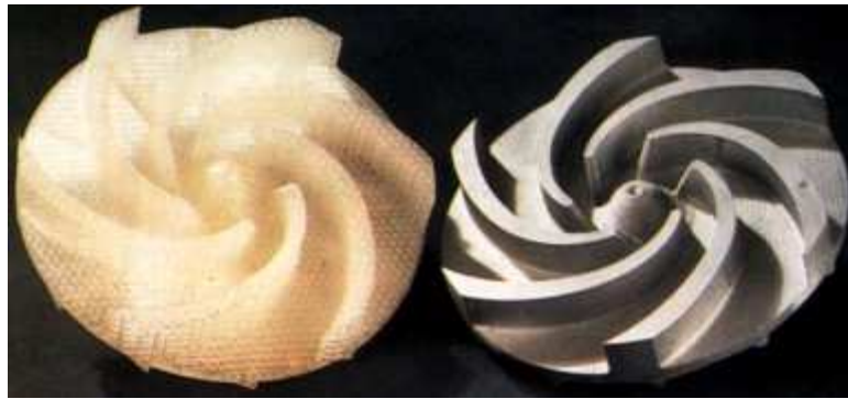
Ilustración 1.5 Prototipo fabricado mediante FDM (izquierda) y CNC (derecha) (UNI, 2016)
