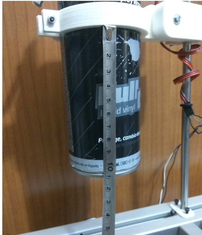
Ilustración 4.4.1 Posición correcta bote de spray
