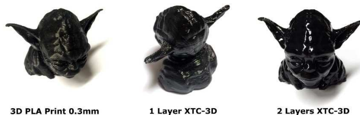
Ilustración 2.10 Recubrimiento de pieza impresa con resina epóxica (3dprinting, 2016)
