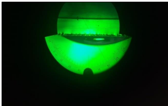
Ilustración 6: Observación a través del sistema óptico ángulo de contacto gota de agua
