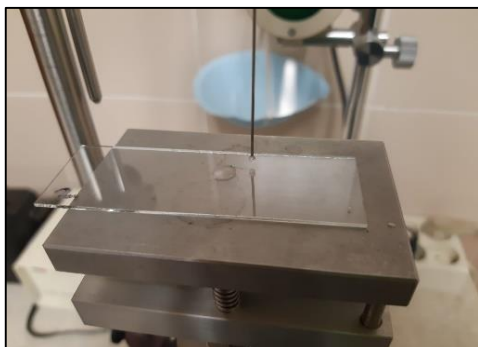
Ilustración 5: Ensayo de medidas de ángulos de contacto
