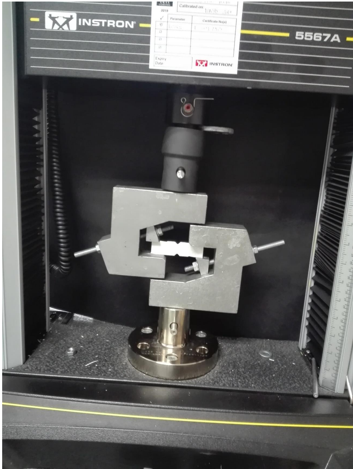
Figura 80 Colocación ensayo cortante
