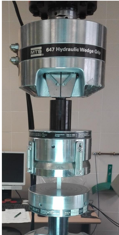
Figura 58 Montaje probetas ensayo compresión
