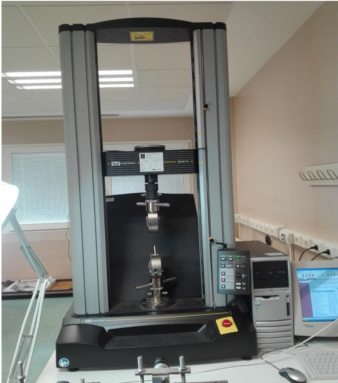
Figura 30 Montaje ensayo tracción
