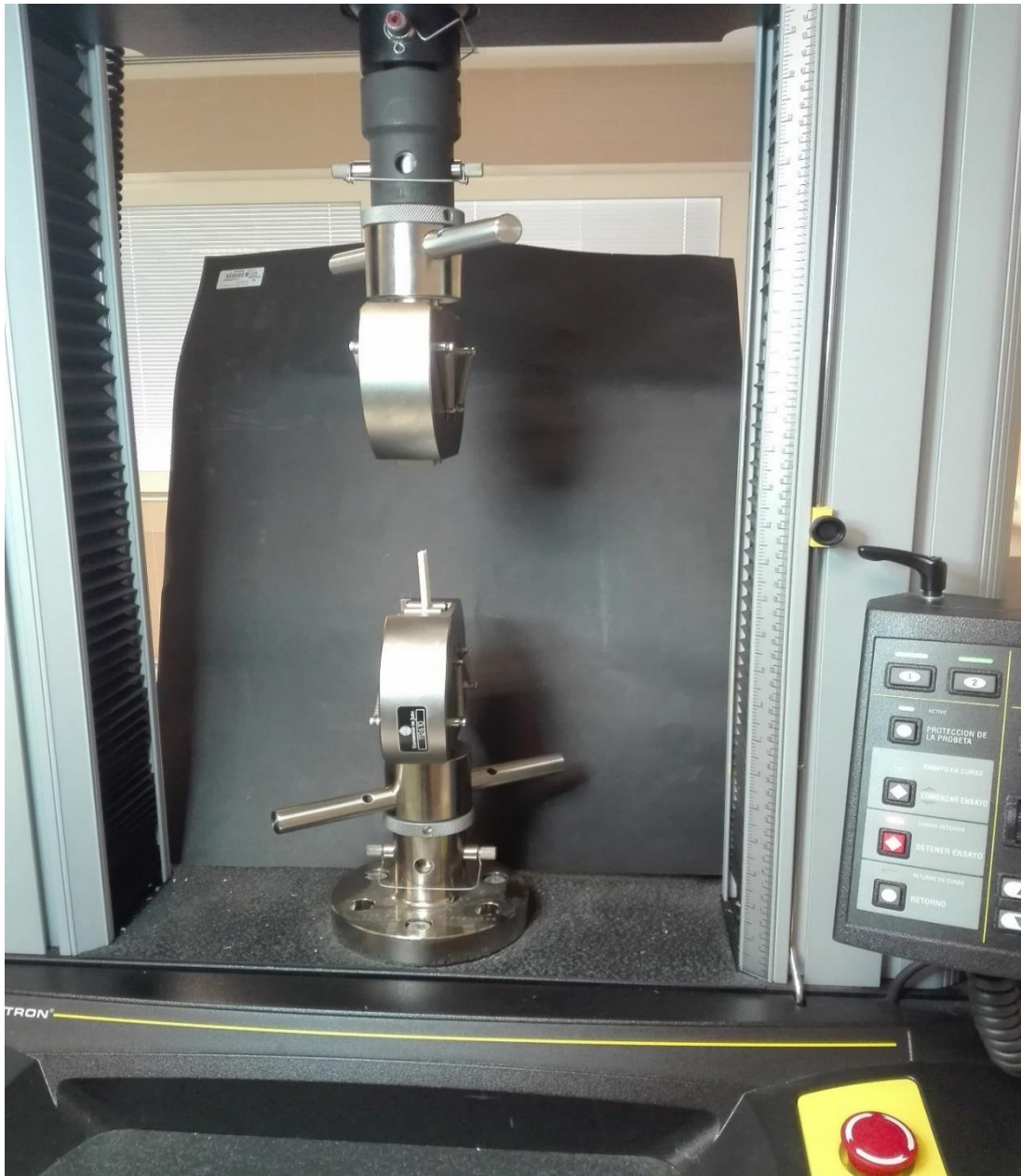
Figura 29 Montaje ensayo tracción
