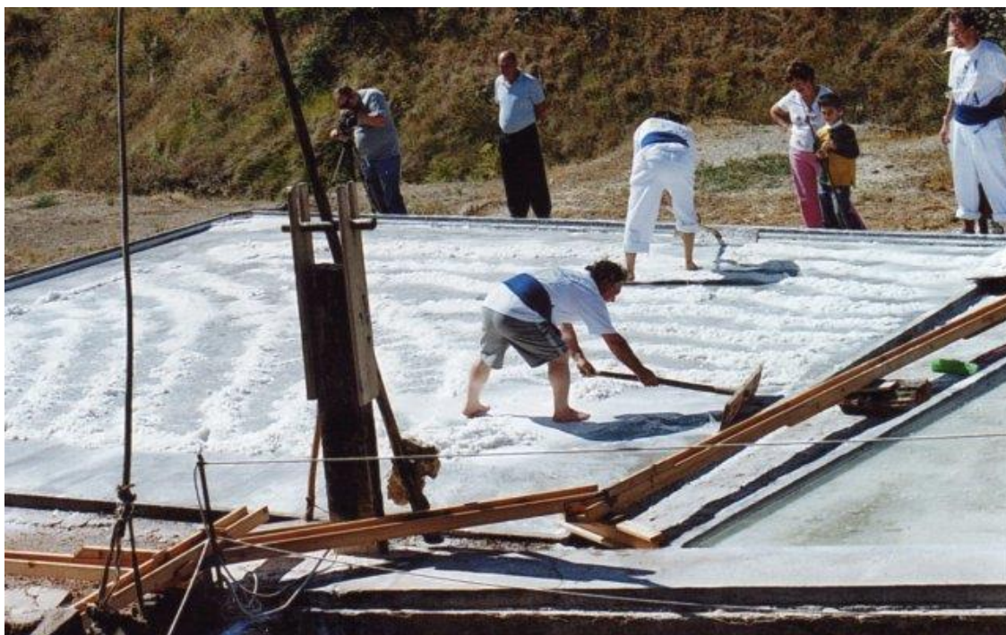
Fig.9: Trabajadores salineros en Burgos raspando con el legón la costra de sal. En primer plano puede apreciarse un cigüeñal de madera, cuyo uso estaba destinado a extraer el agua del pozo ( http://destinocastillayleon.es/index/poza-de-la-sal/ (1/12/16)).
