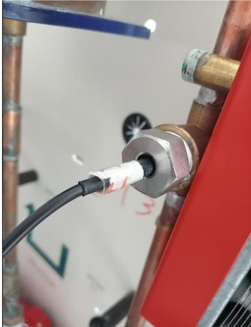
Figura 25 : Sensor de temperatura insertado en la cánula.
