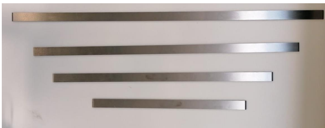
Figura 4.13 Barras del ensayo de influencia de longitus. De superior a inferior son S5, S3, S2 y S1.
