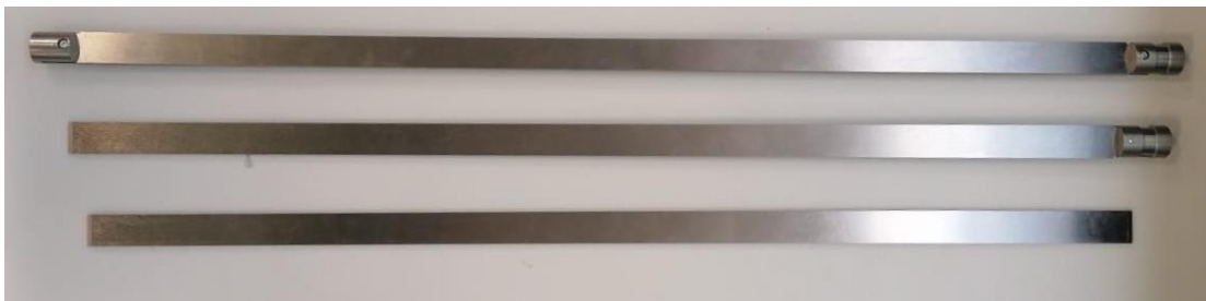
Figura 4.12 Barras del ensayo de influencia de sustentación de superior a inferior son S7, S6 y S4.
