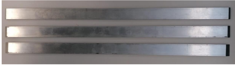
Figura 4.17 Barras del ensayo de influencia de excentricidad. De superior a inferior son SZ1, SZ2 y SZ3.
