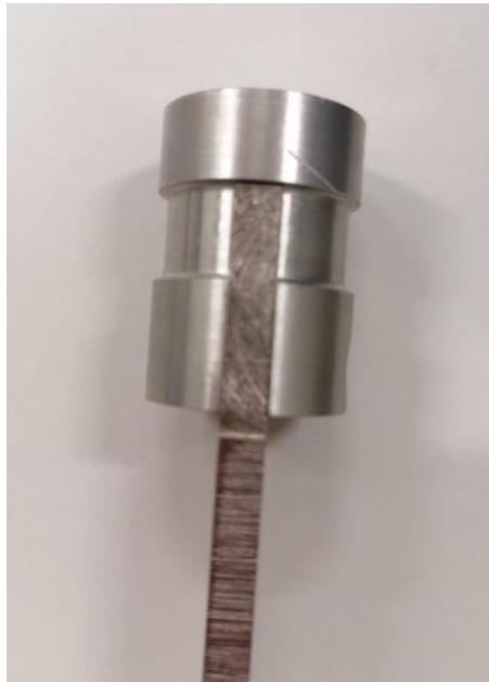
Figura 4.4 Pieza de presión unida a barra, simulando empotramiento.
