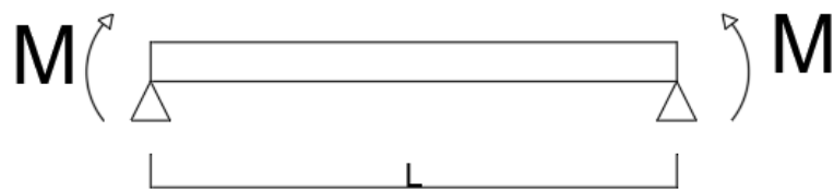
Figura 2.9 Barra sometida a momentos flectores. (Elaboración Propia)
