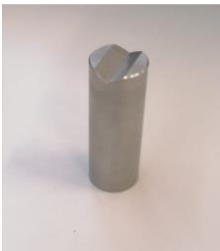
Figura 4.6 Apoyo articulado del alojamiento superior.
