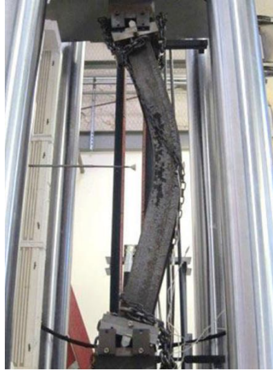
Figura 2.6 Viga sufre pandeo a flexión.
