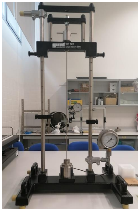
Figura 4.35 Montaje de la barra S5.
