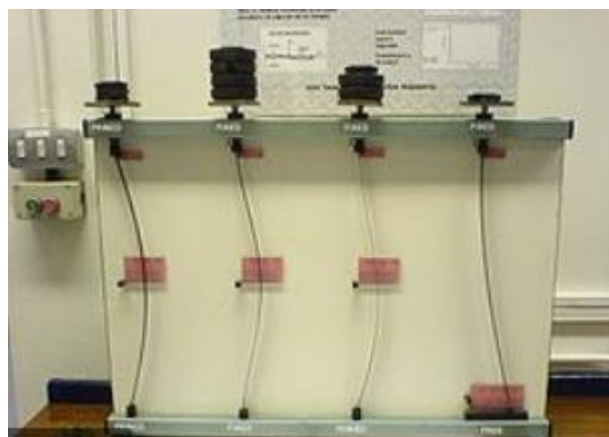
Figura 2.7 Formas de pandeo dependiendo de los apoyos.
