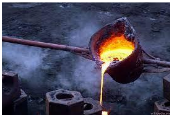
Figura 2.5 Colada de hierro en una fundición.
