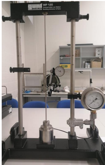
Figura 4.34 Montaje de la barra S3.
