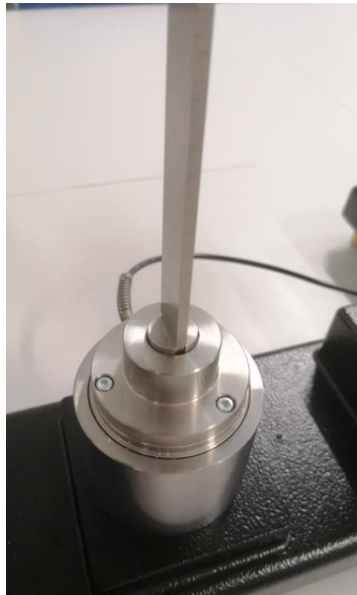
Figura 4.23 Alojamiento inferior de la barra S7 que representa un empotramiento. En el alojamiento superior se usa una pieza corta para que la fuerza del torno superior sea aplicada, como se observa en la figura 4.24.
