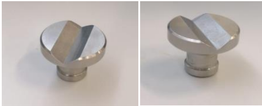
Figura 4.3 Apoyo articulado del alojamiento inferior.
