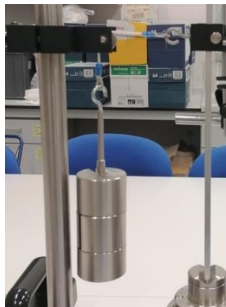
Figura A2.6 Dispositivo de carga transversal.
