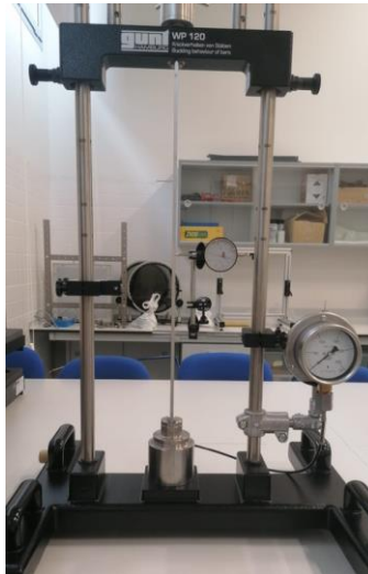
Figura 4.37 Montaje de la barra S8.
