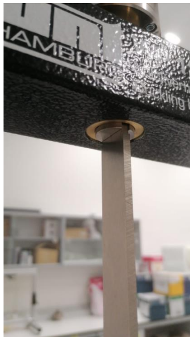
Figura 4.24 Alojamiento superior de la barra S7 que representa un empotramiento.
