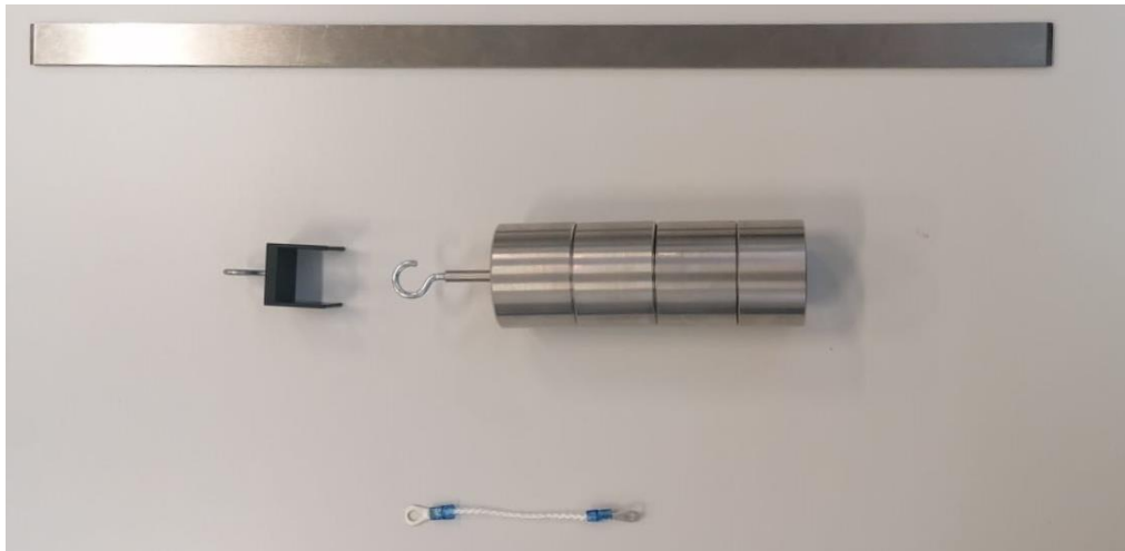
Figura A2.5 Barra SZ1 y dispositivos de carga.
