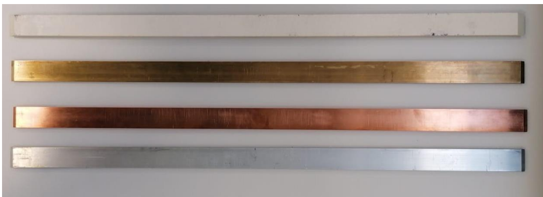
Figura 4.14 Barras del ensayo de influencia de longitud. De superior a inferior son S11, S9, S10 y S8.
