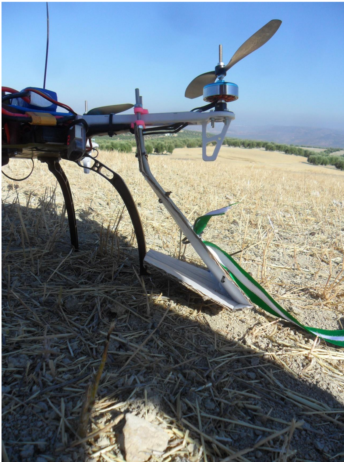
Figura 160. Situación del primer deflector, previo al vuelo.
