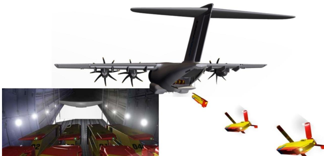
Figura 14. Nitrofirex. Proyecto para extinción de incendios. (Andalucía., 2016)
