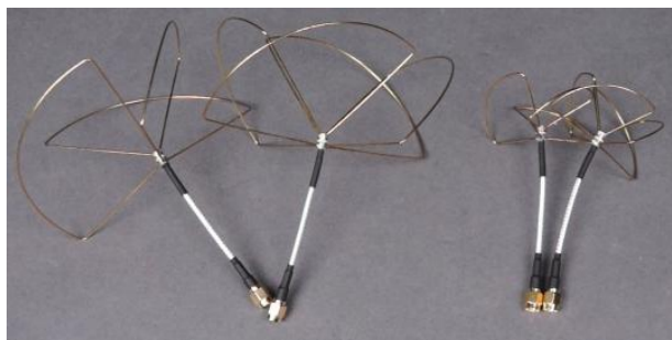
Figura 20. Antenas de polarización circulares omnidireccionales. (Izquierda) antena de 700 MHz. (Derecha) antena de 5.8 GHz.
