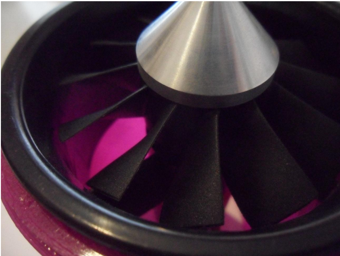
Figura 54. Detalle de la torsión de los álabes en la turbina utilizada. Para mantener el flujo másico constante a través de la sección transversal de esta se torsionan los álabes como se muestra (Peragón).
