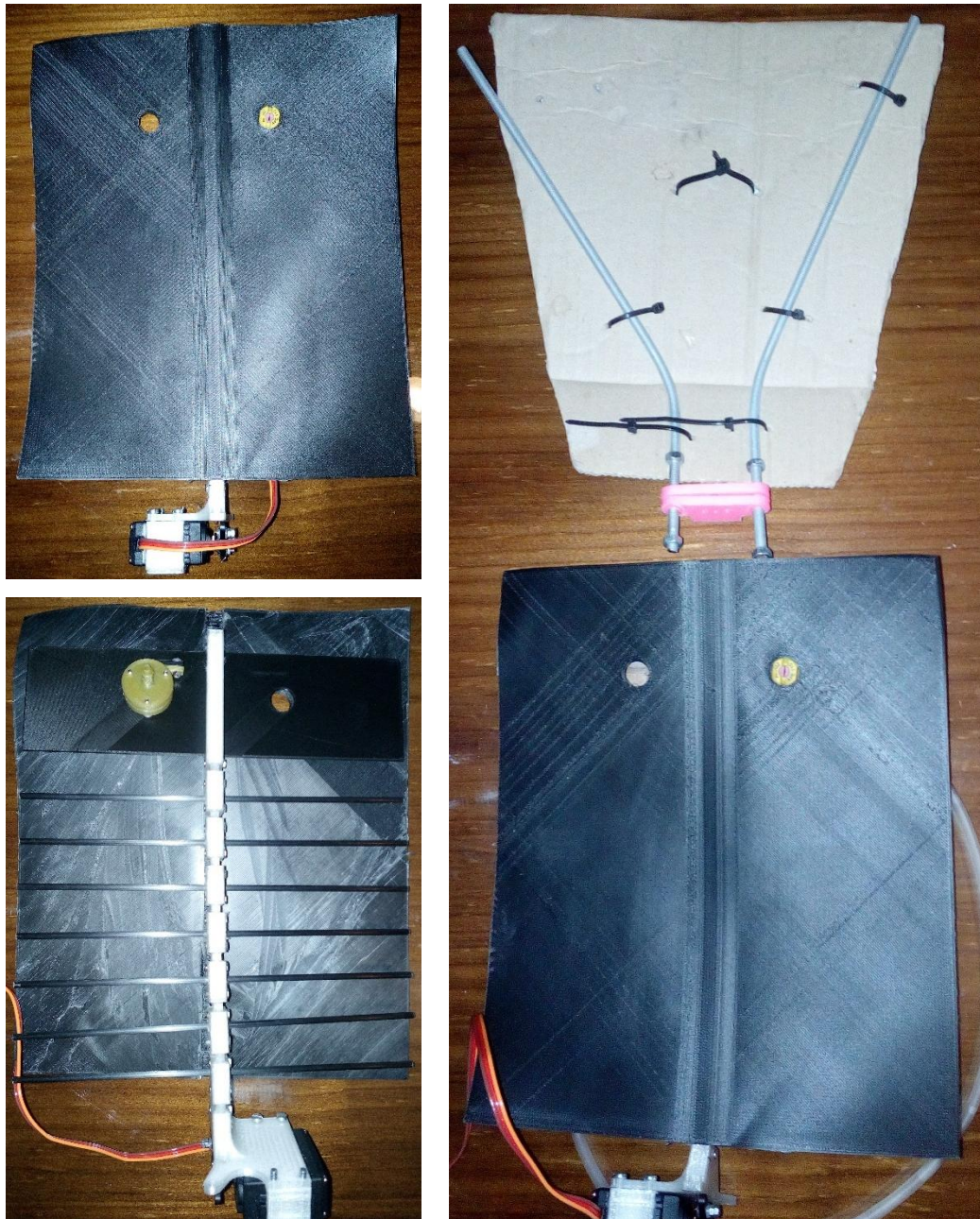
Figura 153. Vistas del deflector (izquierda). Comparativa del deflector construido para la prueba experimental inicial y deflector construido posterior al estudio.
