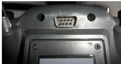
Figura 38. Puerto para reprogramación de emisora.
