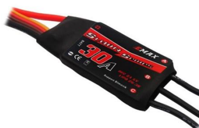
Figura 32. Controlador utilizado. 12,5V DC. Burst: 40A
