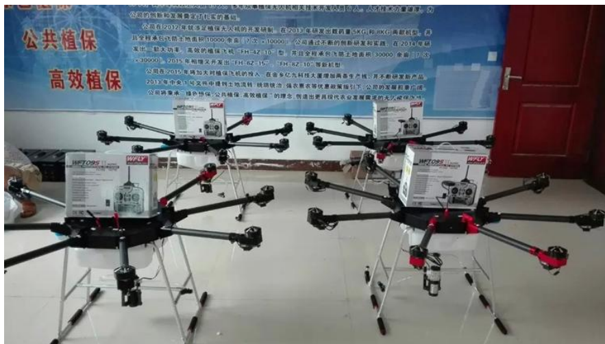
Figura 3. FH-8Z-10 UAV Drone Crop Sprayer. Solución comercial para aplicación de fitosanitarios. (Sprayer.)
