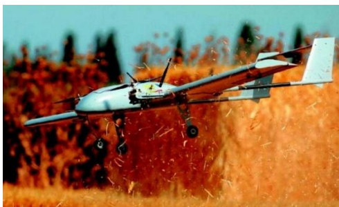
Figura 2. UAV VTOL con ala fija. (Post-Afghanistan Era, 2014)
