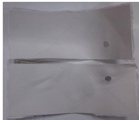
Figura 151. Impresión de superficie deflectora con PLA Soft de Orbi-Tech. Se aprecia cómo no recupera la forma tras ser deformado.
