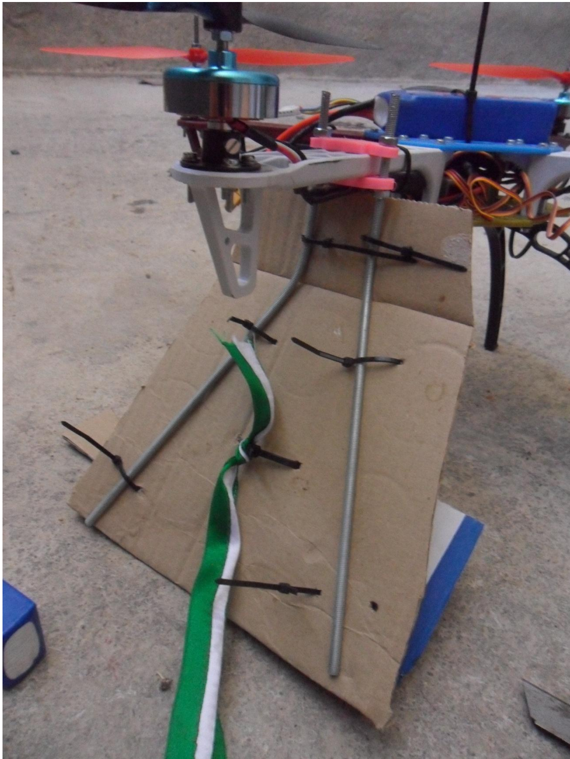
Figura 161. Deflector simplificado, fabricado con varilla roscada, cartón y soporte en ABS.
