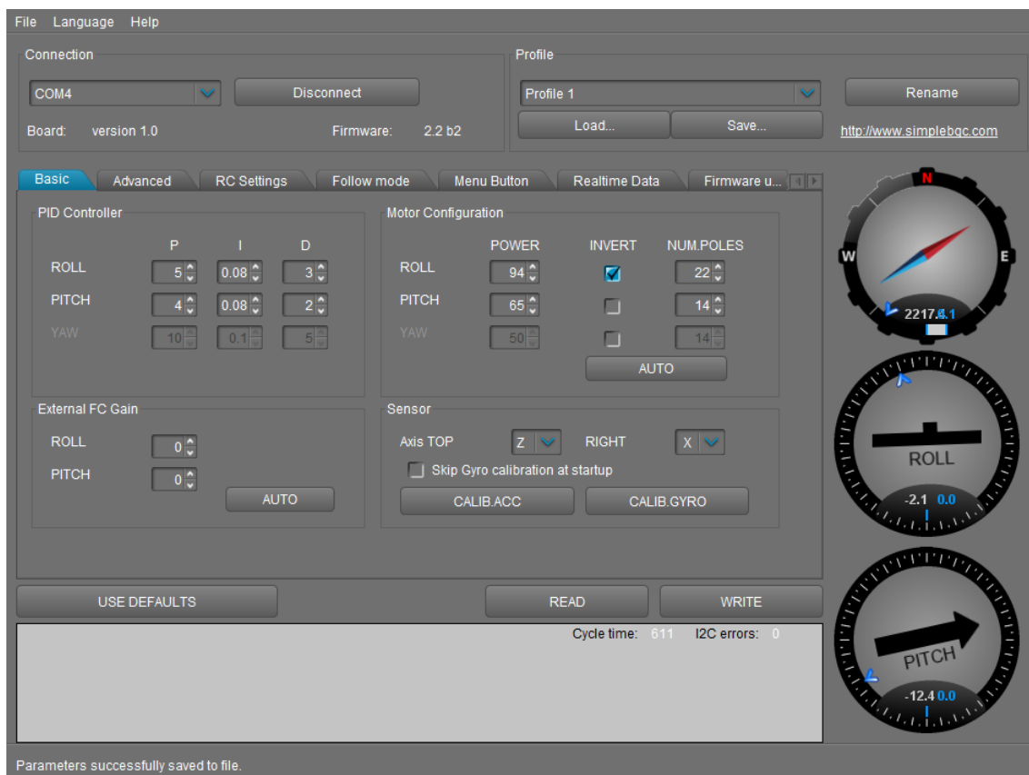
Figura 58. Simple BGC GUI 2.2 o interfaz de programación del estabilizador gimbal. Además para su programación también se requiere del uso del firmware XLoader con avrdude.conf (Miller, y otros)
