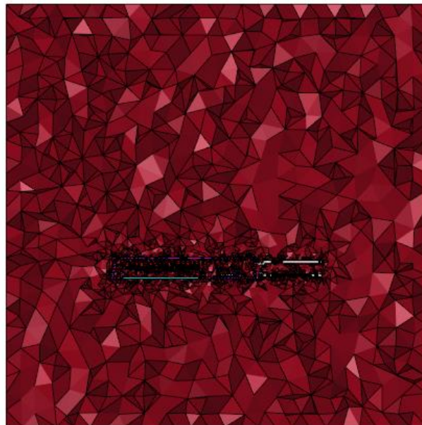
Figura 33. Sección media de los componentes y aire generados con tetraedros. Modelo B. Fuente: Elaboración propia a partir del software HYPERMESH
