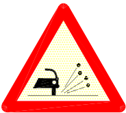
TP-28 PROYECCION DE GRAVILLA
