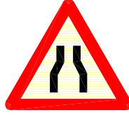
TP-17 ESTRECHAMIENTO DE CALZADA
