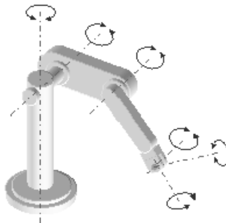
Figura 6 Los distintos grados de libertad de un brazo de robot
