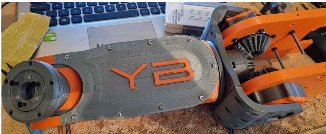
Figura 83 Ensamblaje articulaciones 3/4, 5 y 6
