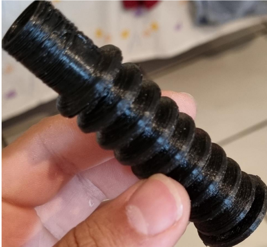
Figura 84 guía flexible para los cables
