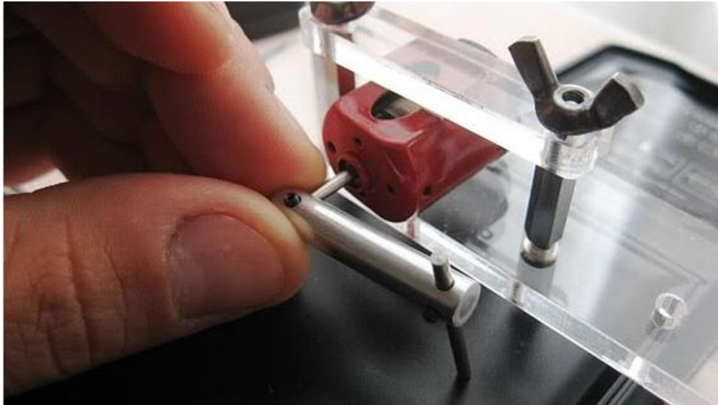
Figura 6. 2. Fijación del brazo al eje del motor.
