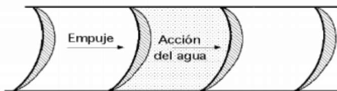
Figura 2. 10. Turbina de acción.
