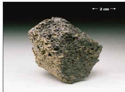
Ilustración 9. Esta imagen muestra una escoria, material piroclástico caracterizado por la presencia de vesículas o huecos, producto del magma basáltico (Edward & Frederick, 2018).
