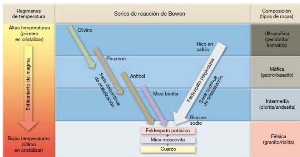
Ilustración 5. Series de reacción de Bowen. Relación entre la temperatura y la cristalización de los distintos minerales, en función de los diferentes puntos de fusión de los mismos (Edward & Frederick, 2018).
