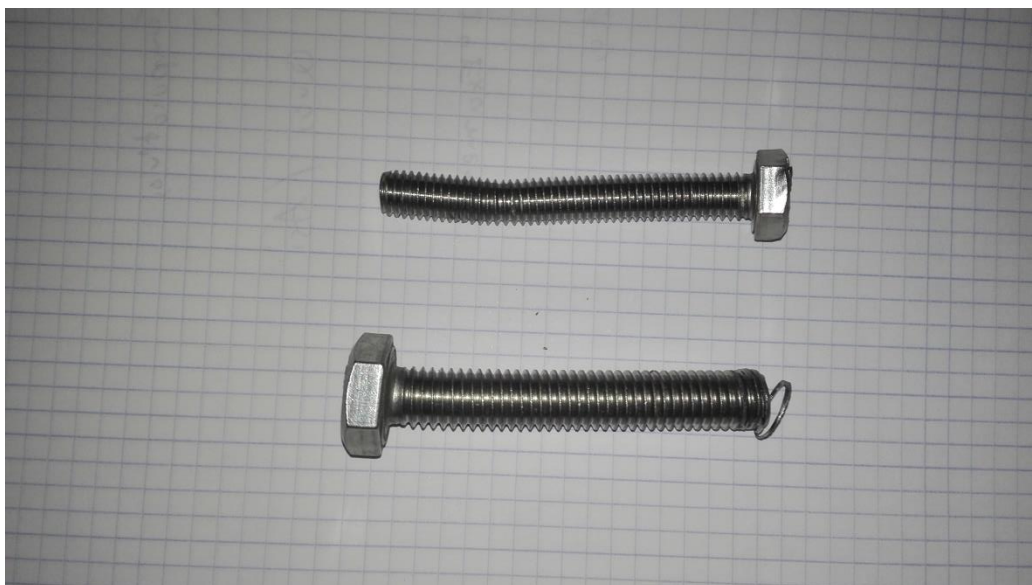
Figura 87: Tornillos deformados correspondientes al modelo 25.1 (arriba) y del modelo 35.2 (abajo).
