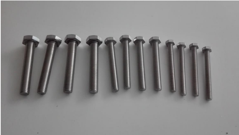
Figura 30: Tornillos utilizados en el ensayo de acero inoxidable A2-70.
