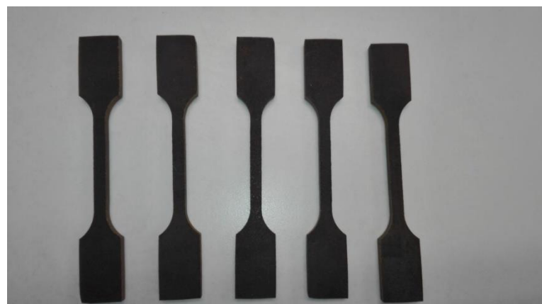
Figura 105: Probetas del alma mecanizadas.
