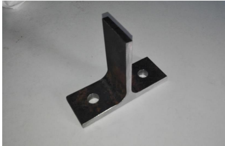
Figura 29: Perfil T con los agujeros realizados.
