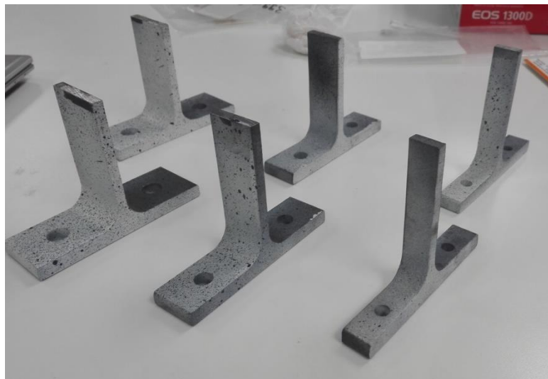
Figura 31: Perfiles T pintadas con moteado.
