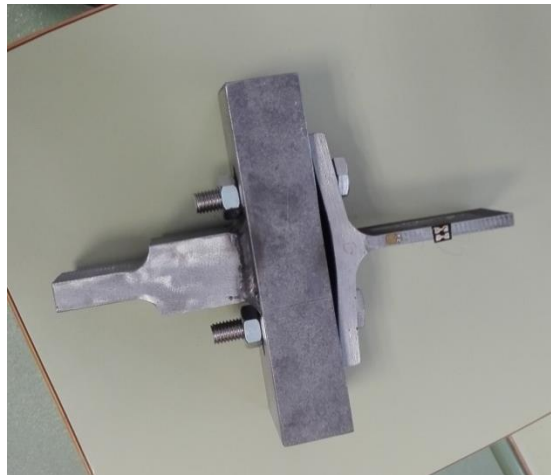
Figura 42: Modelo 35.2 montado en el soporte después del ensayo.
