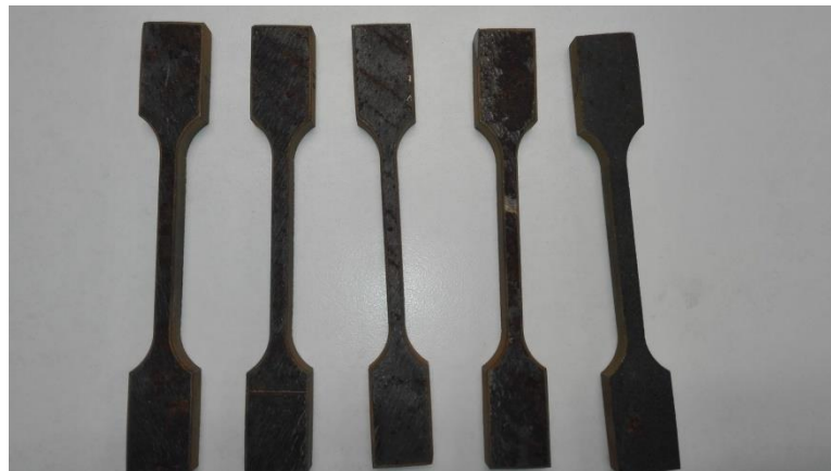
Figura 104: Probetas del ala mecanizadas
