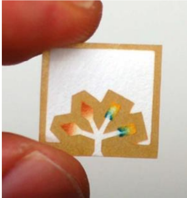
Fig. 5.14 Papel microfluídico utilizado en la técnica NAATs (Martinez et al. , 2009).
