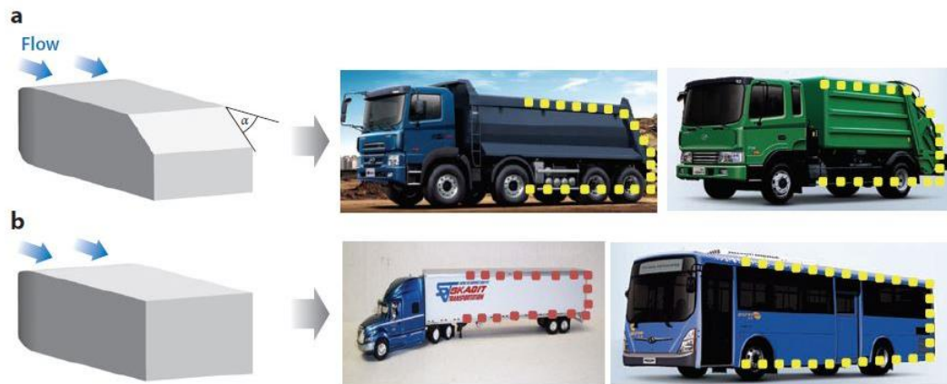
Figura 2. Modelos simplificados y su relevancia geométrica para vehículos pesados, (a) Modelo Ahmed y (b) Modelo GM (Choi et al., 2014)
