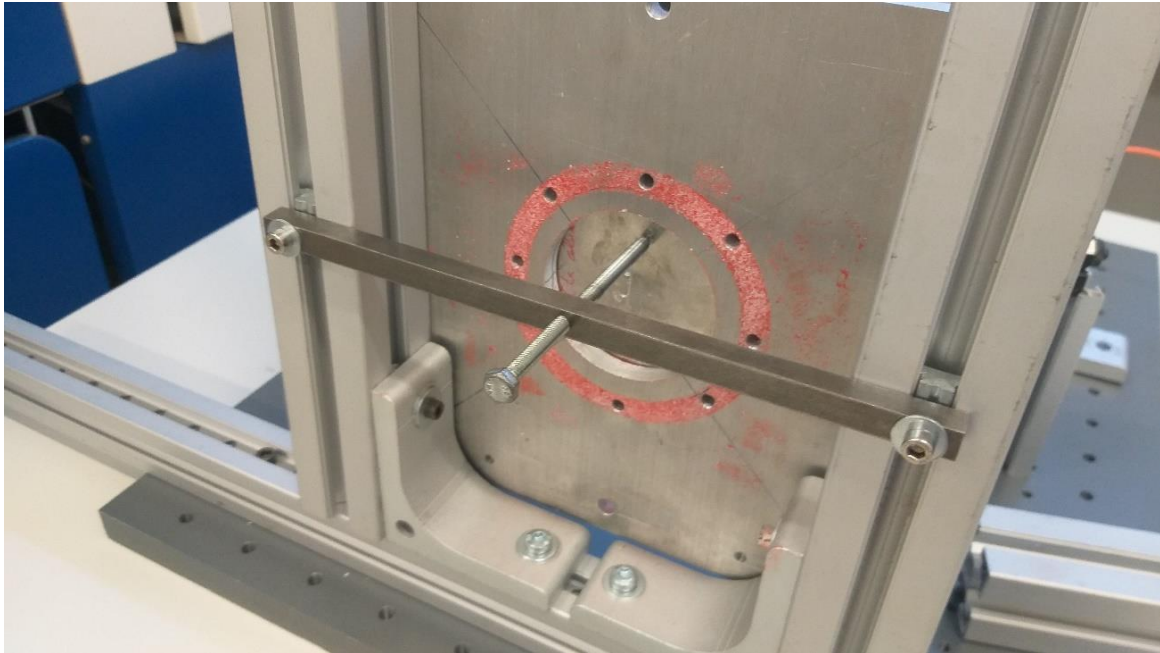
Figura 5.22-. Parte trasera del soporte vertical para la sujeción de la muestra a ensayo. Tornillo de apriete
