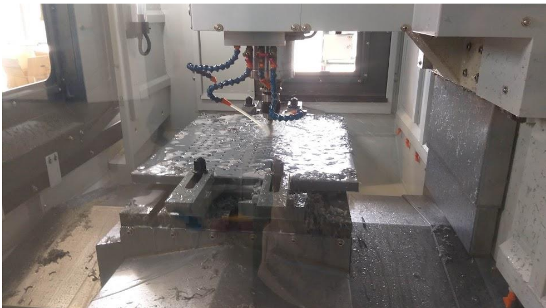
Figura 5.12-. Base universal para ensayos en su proceso de fabricación mediante CNC
