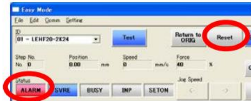
Figura 5.37. Estado de alarma en ACT Controller [15]
