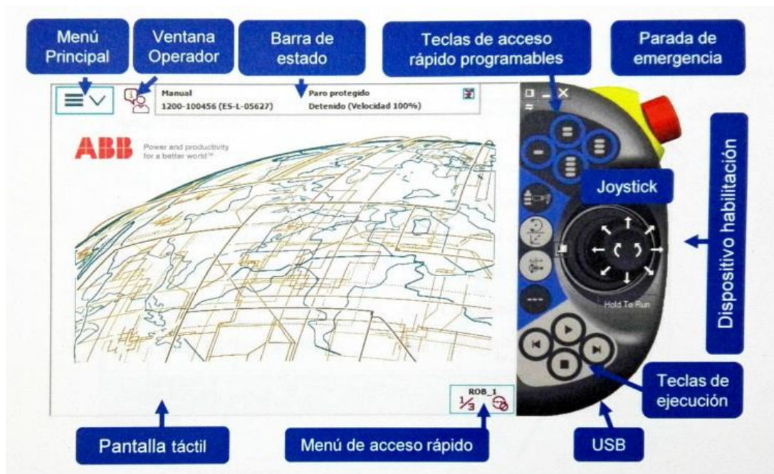
Figura 5.9. Distribución de botones de FlexPendant [8]
