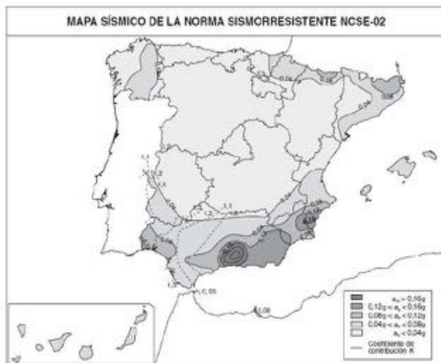
Figura 19. Mapa peligrosidad sísmica. NC SE-02 [13]
