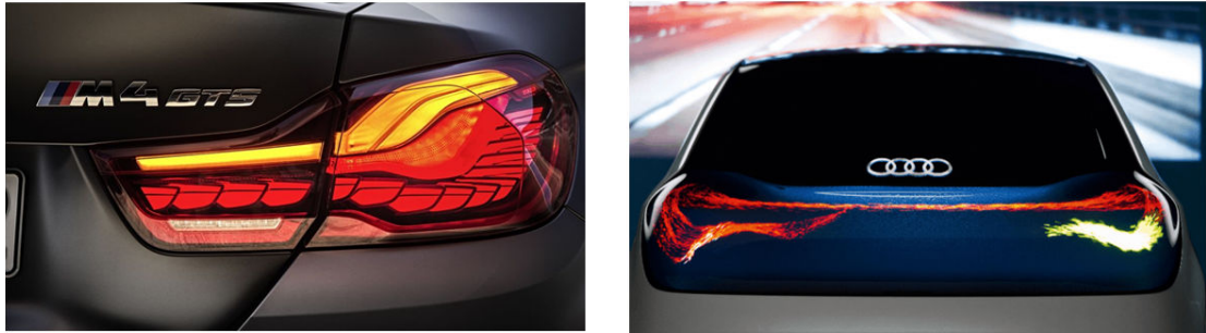
Ilustración 55 Pilotos Oled del Bmw M4 y Audi A8 respectivamente
