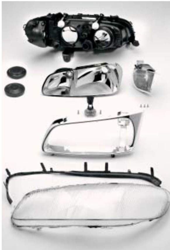
Ilustración 18 Despiece de un faro halógeno
