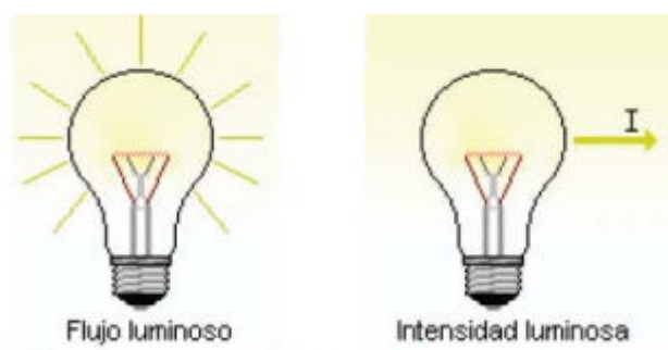
Ilustración 82 Diferencia entre flujo luminoso e intensidad luminosa
