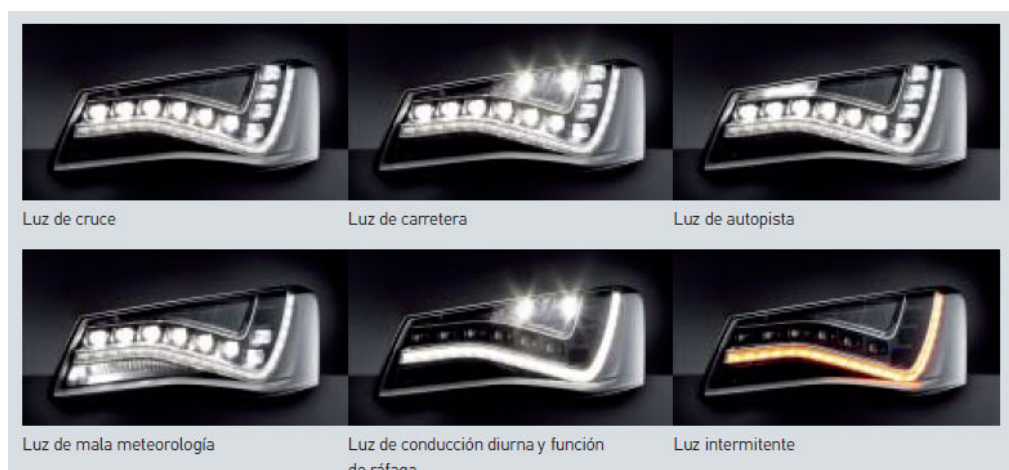
Ilustración 33 Funciones luminosas del proyector del Audi A8
