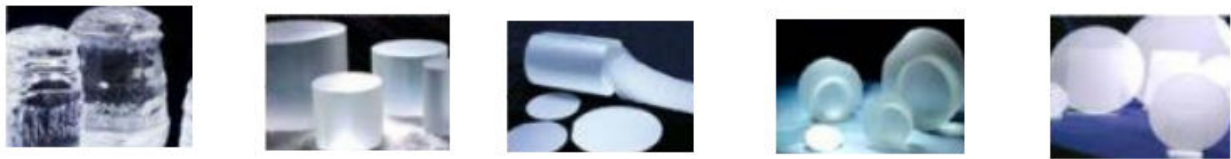
Ilustración 8 Fases de fabricación de obleas para obtener led
