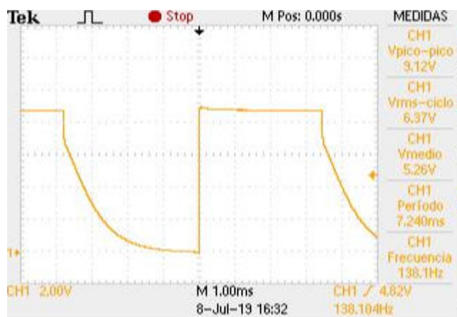
Ilustración 147 Tensión por los led experimentalmente para R_2=48K\Omega
