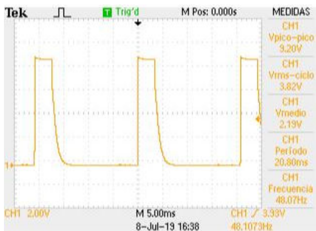
Ilustración 148 Tensión por los led experimentalmente para R_2=220K\Omega
