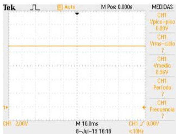
Ilustración 146 Tensión por los led experimentalmente para R_2=1\Omega
