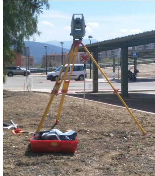
Imagen 3.2. Estación Total TCRA 1203 y trípode. Fuente: Elaboración propia.
