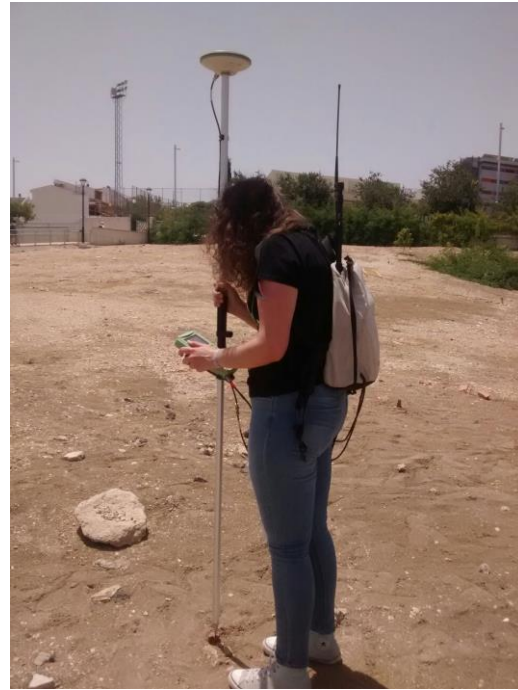
Imagen 3.10. GPS Leica System 1200 (Antena, receptor y jalón). Fuente: Elaboración propia.
