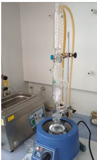
Figura 11: Extracción Soxhlet junto con la muestra de film
