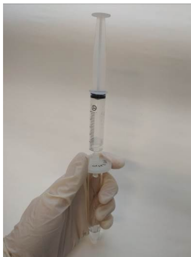
Figura 15: Filtración de la fase líquida
