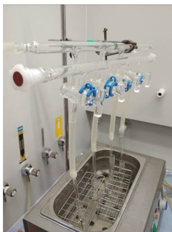
Figura 16: Eliminación de disolventes en baño termostático con aportación de nitrógeno
