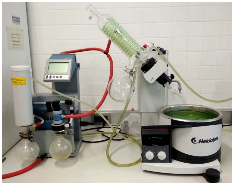
Ilustración 13: Equipo rota vapor utilizado en la eliminación de disolventes
