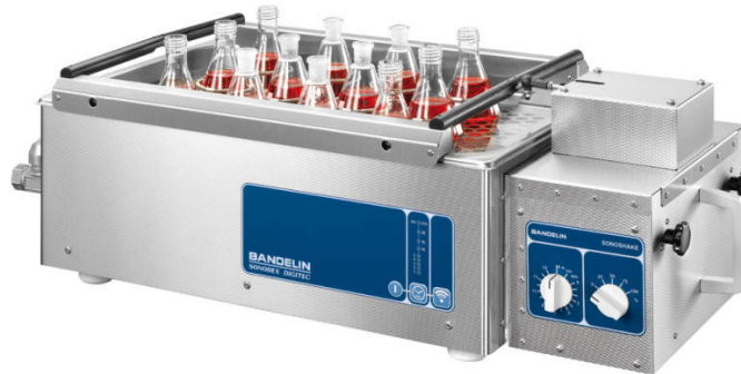
Figura 9: reactor tipo baño ultrasónico
