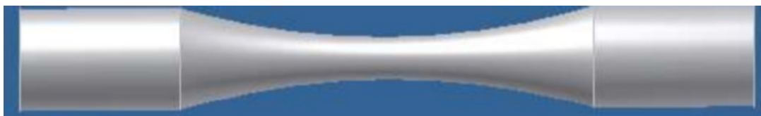
Figura 30: Tipo de probeta para ensayos de fatiga en flexión rotativa [10].
