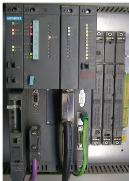
Imagen 2. Control lógico programable. Imagen de Mixabest en Wikimedia. Dominio público
