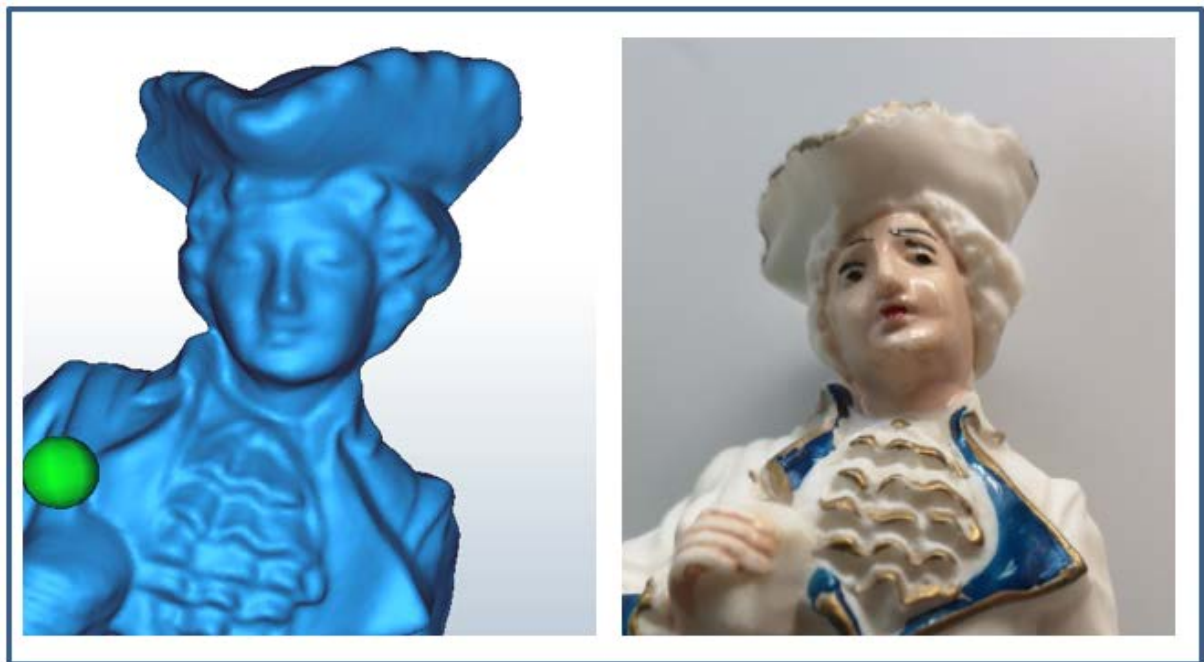
1 Figura 54. Diferencias pieza porcelana: modelo 3D - pieza real.
