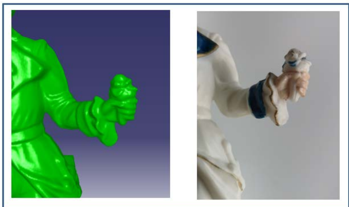
Figura 53. Diferencias pieza porcelana: modelo 3D - pieza real.
