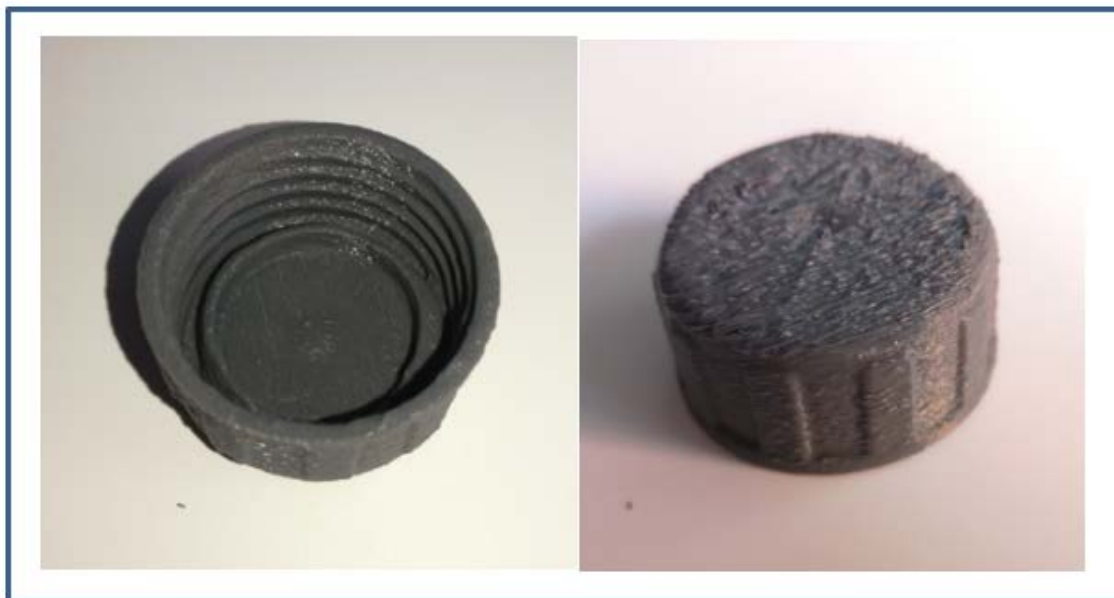
Figura 70. Tapón - impresión 3D.
