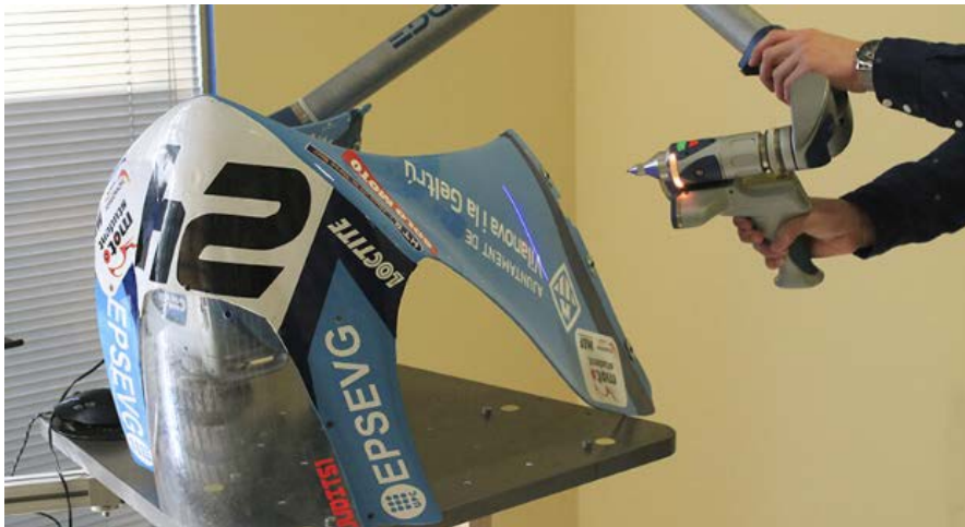
Figura 4. Obtención del modelo 3D mediante ingeniería inversa.
