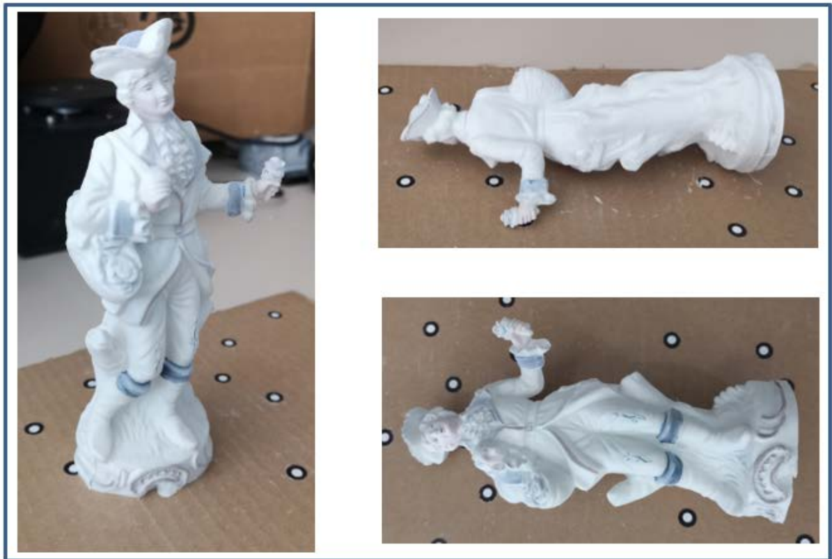
Figura 33. Diferentes posiciones escaneado pieza de porcelana.
