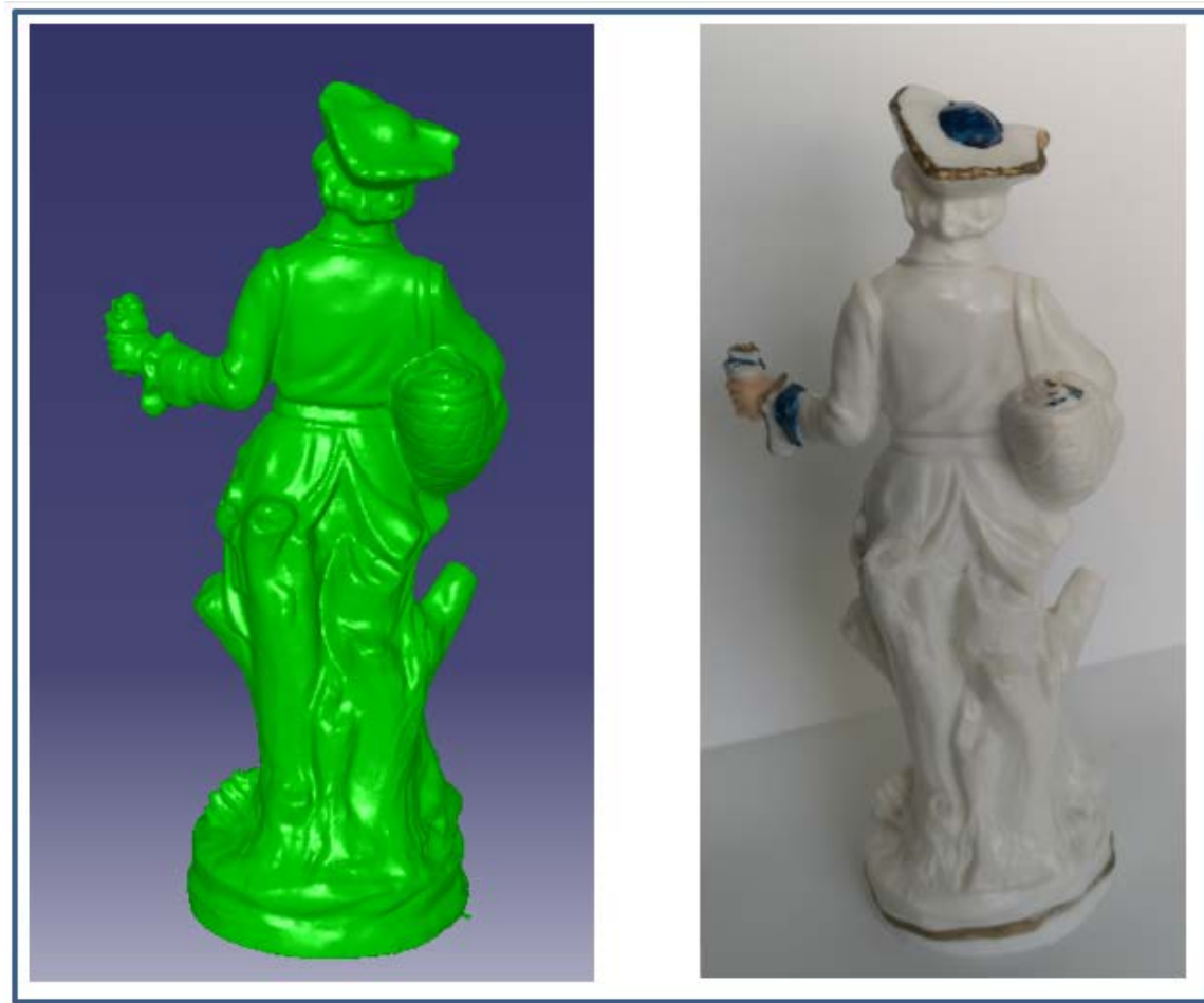
Figura 52. Diferencias pieza porcelana: modelo 3D - pieza real.
