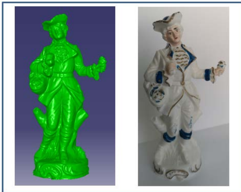
Figura 51. Diferencias pieza porcelana: modelo 3D - pieza real
