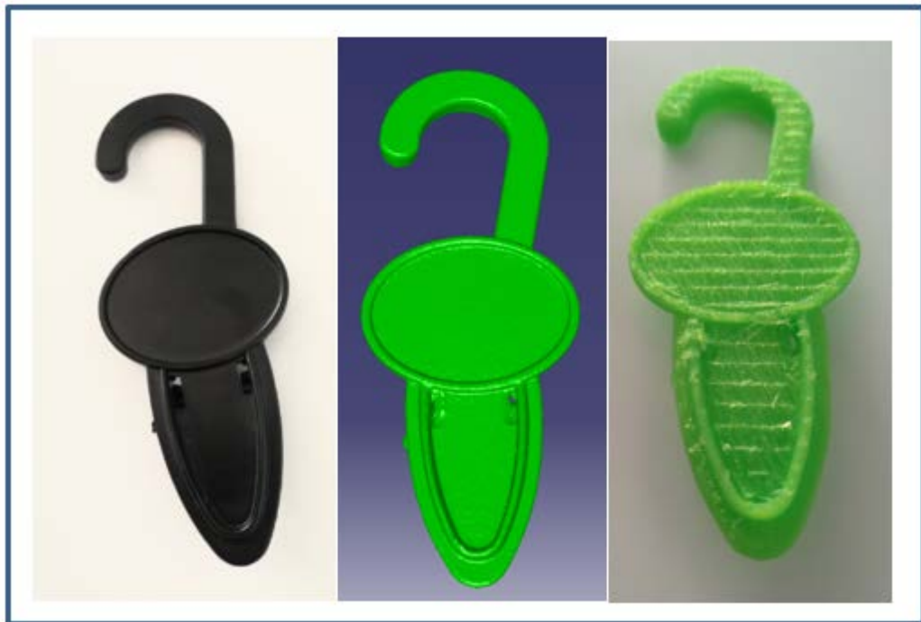
Figura 61. Pieza 2 percha, detalle agujeros: real - modelo 3D - impresión 3D.
