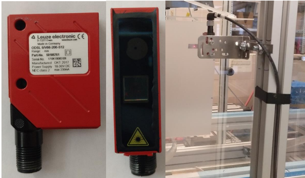
Figura 25. Láser para medir la amplitud y colocación.
