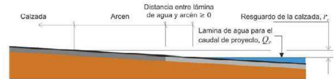
FIGURA 3.2.- RESGUARDO DE LA CALZADA
