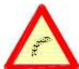
TP-13A CURVA PELIGROSA HACIA LA DERECHA
