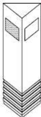
HITOS CAPTAFAROS PARA SEÑALIZACION LATERAL DE AUTOPISTA EN POLIETILENO
