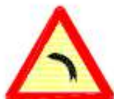
TP-13B CURVA PELIGROSA HACIA LA IZQUIERDA
