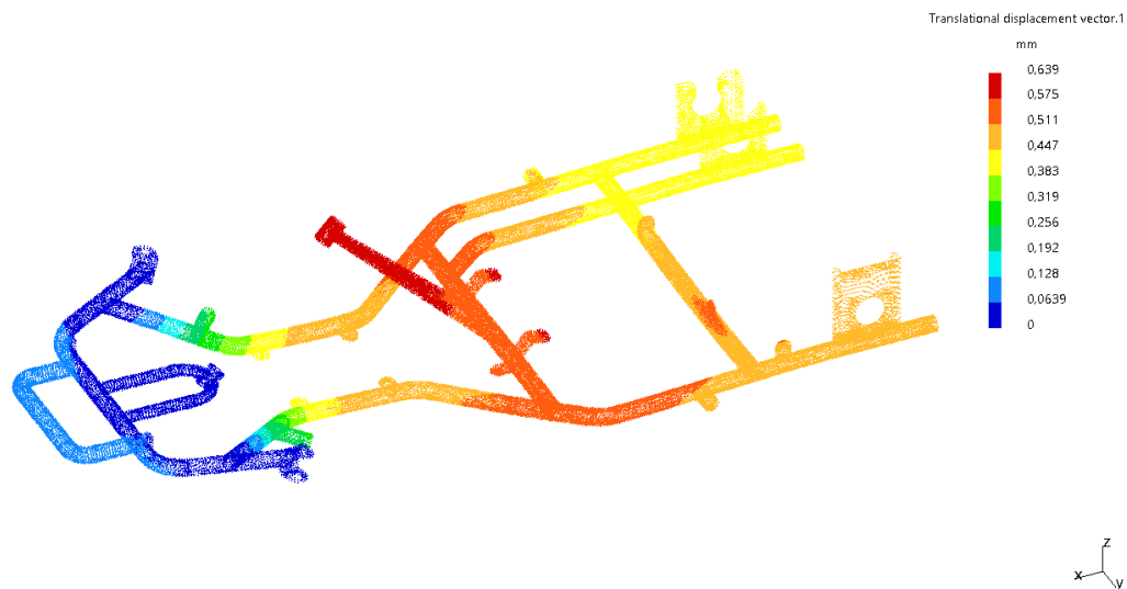
Figura 3.49. Desplazamientos del chasis en aceleración longitudinal
