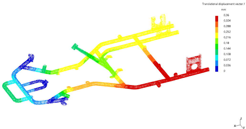
Figura 3.53. Desplazamientos del chasis en desaceleración longitudinal
