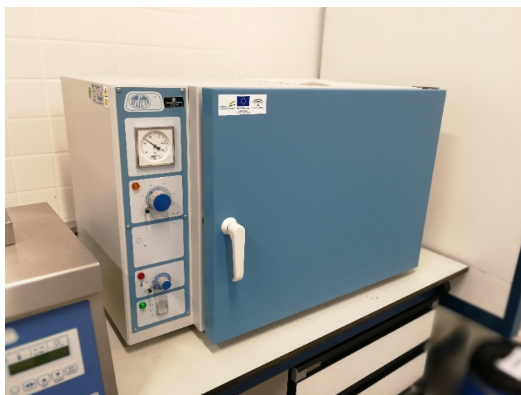
Figura 4.1 Estufa empleada para determinar contenido de humedad, marca: Selecta
