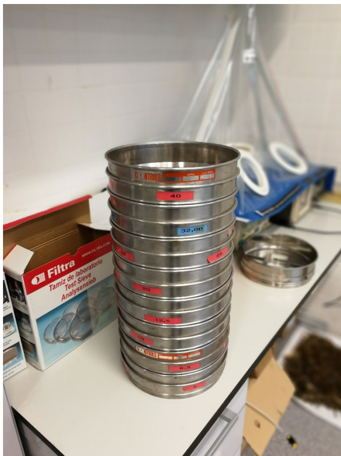
Figura 4.4 Batería de tamices empleado, marca: Controls
