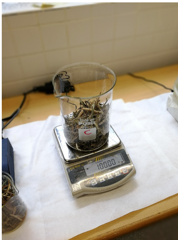
Figura 4.2 Tarado de una de las muestras en balanza analítica, marca: Kern
