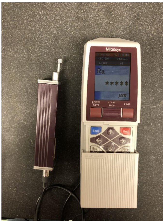
Figura 4.4: Rugosímetro Mitutoyo Surftest SJ 210.
