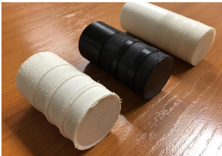
Figura 4.10: Probetas de los ensayos de torneado.
