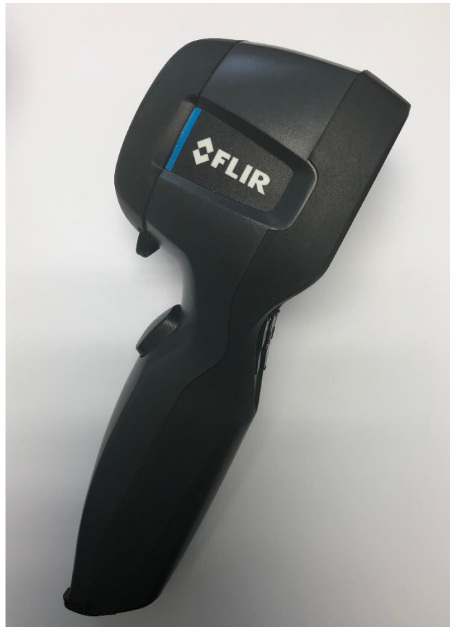
Figura 4.7: Cámara de imagen térmica FLIR i3.
