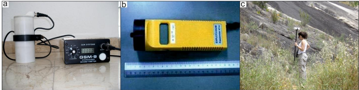
Figura 21. Equipos de medida (a) magnetómetro GSM 8 de precesión de protones; (b) susceptómetro Exploranium kappameter KT-9; (c) Realización de medida de la intensidad del campo magnético total.
