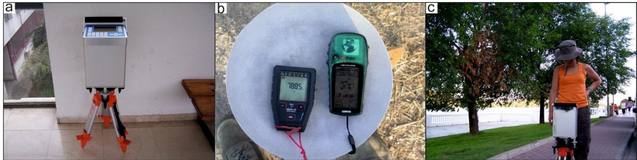
Figura 20. (a) Gravímetro Scintrex Autograv CG-05 sobre trípode; (b) Altímetro barométrico y GPS Garmin e-trex; (c) Realización de una medida gravimétrica sobre trípode.
