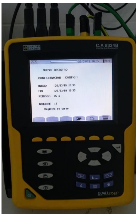
Figura 4.8. – Analizador de redes. Fuente propia.
