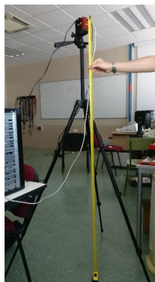
Figura 38: Medición manual de la altura a la que se encuentra situada la cámara TOF
