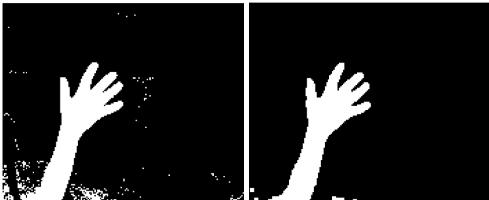
Figura 34: Imagen diferencial antes y después del proceso morfológico de eliminación de ruido
