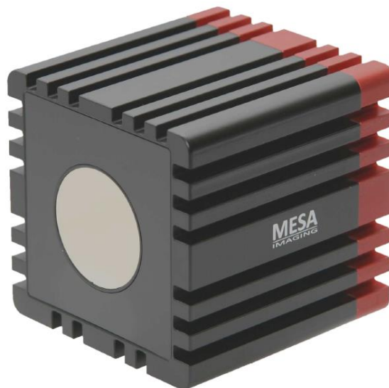
Figura 13: Cámara de tiempo de vuelo SR4000, de Mesa Imaging
