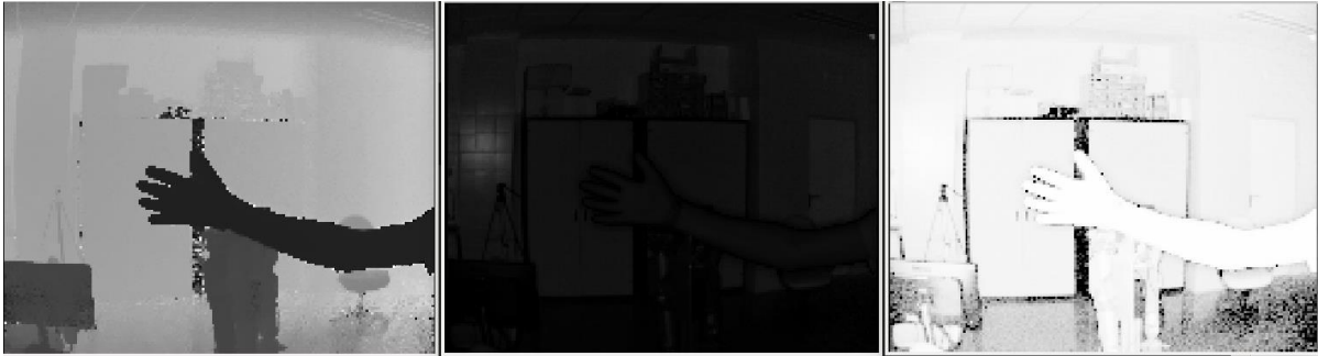
Figura 12: De izquierda a derecha, imágenes de profundidad, intensidad y mapa de confianza generadas por una TOF
